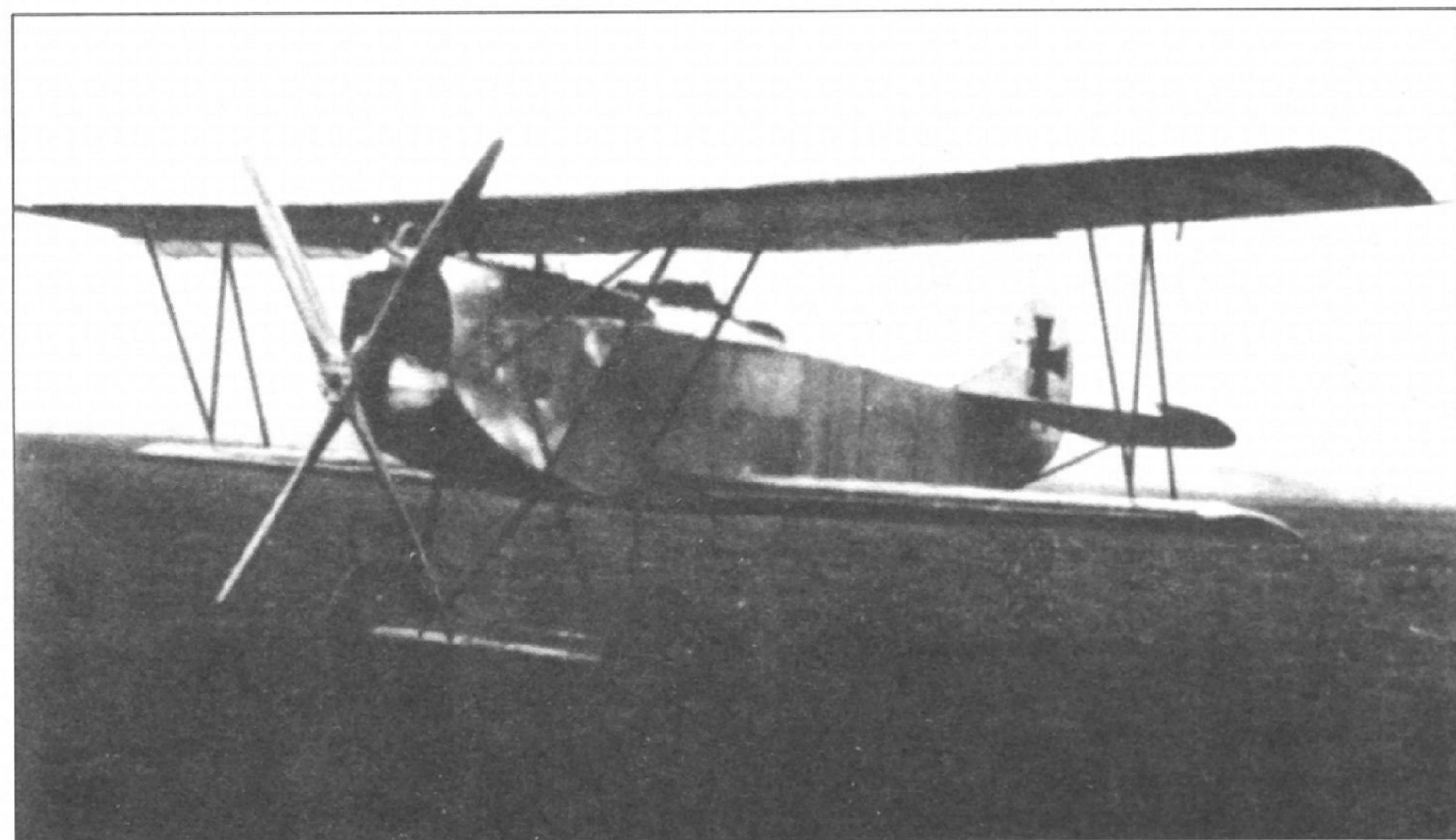
Фоккер V22 с мотором «Австро-Даймлер» и винтом «Ярай»
