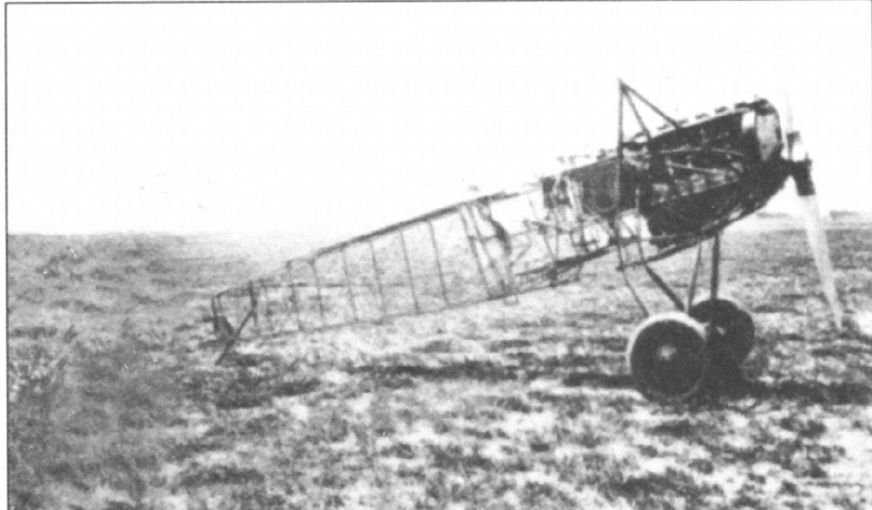
На этом снимке отлично виден металлический каркас фюзеляжа D.VII
