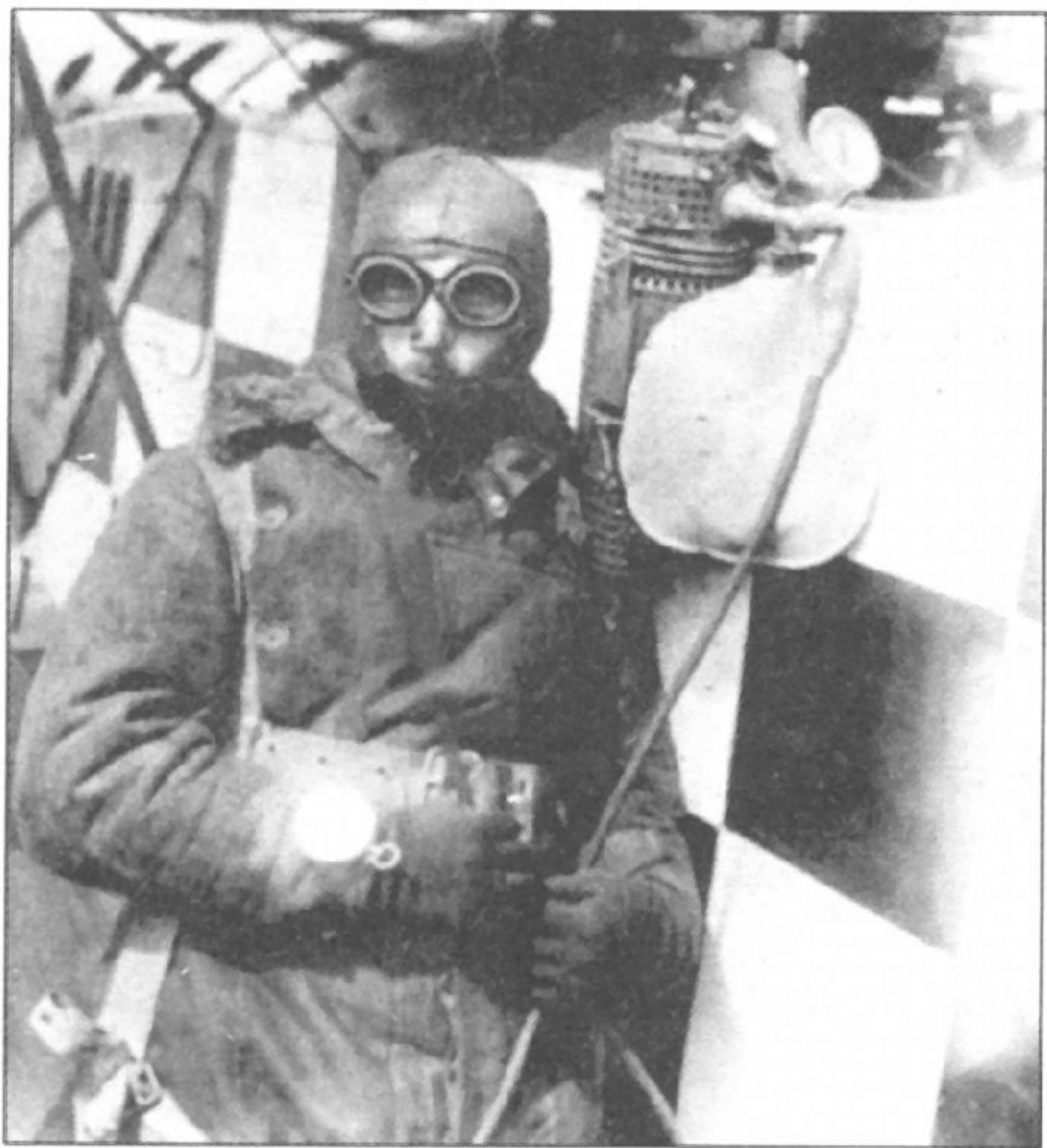
Пилот 74-й истребительной эскадрильи в снаряжении для высотных полётов демонстрирует кислородный аппарат
