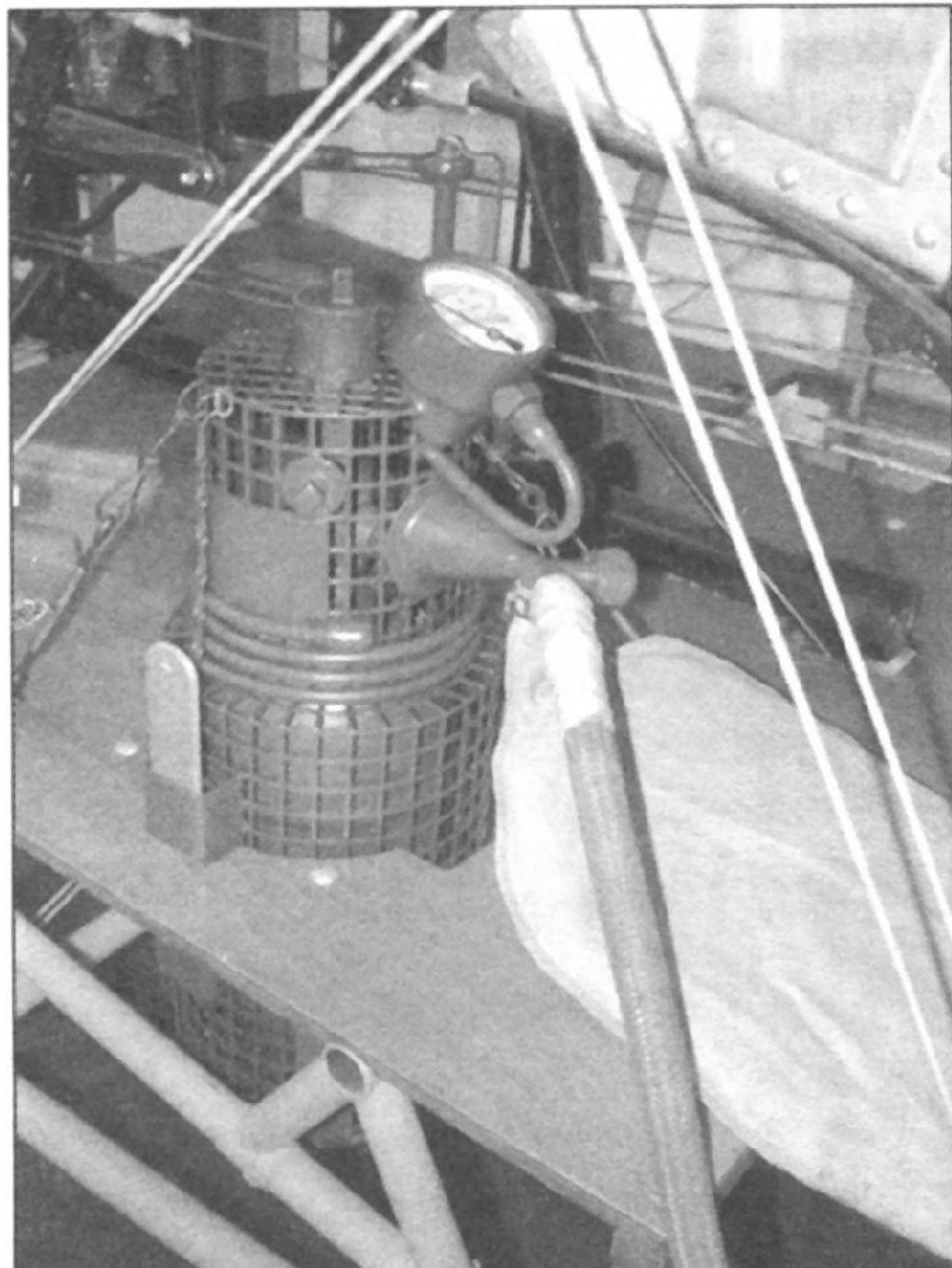
Кислородный прибор, устанавливавшийся на истребителях с мотором BMW IIIa
