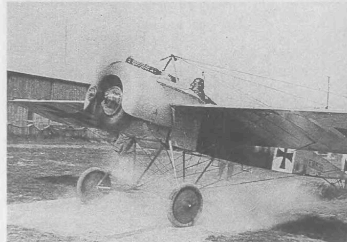
Dieses Foto der Fokker E III 636/15 läßt deutlich erkennen, daß die Umlaufmotoren zusammen mit der Luftschraube rotierten.
