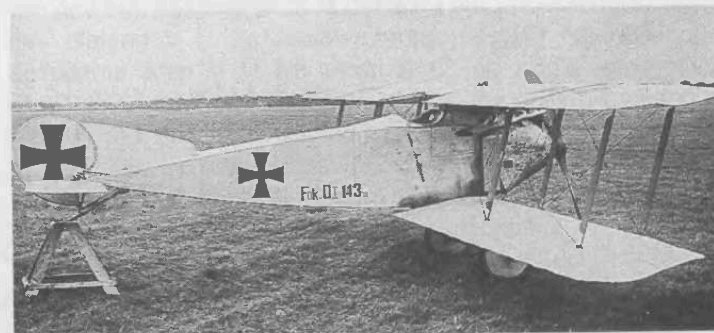
Eine Reihe der Fokker D I erhielten eine zusätzliche Seitenflosse zur Erhöhung der Richtungsstabilität. Hier die Fokker D I 143/16 bei der Feldflieger-Abteilung 48.
