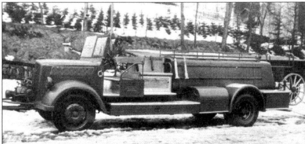
Пожарный насос фирмы Коебе (Luckenwalde), построенный на шасси Opel-Blitz для заводов Junkers в Бреслау.
