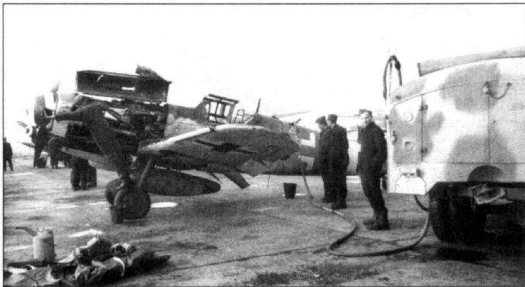
Заправка Messerschmitt Bf109G аэродромным заправщиком на стандартном 3-тонном шасси (4x2). Фото 1944г.
