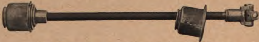
Abb. 75. Kardanwelle mit zwei Kardangelenken und Schutzbüchsen.
