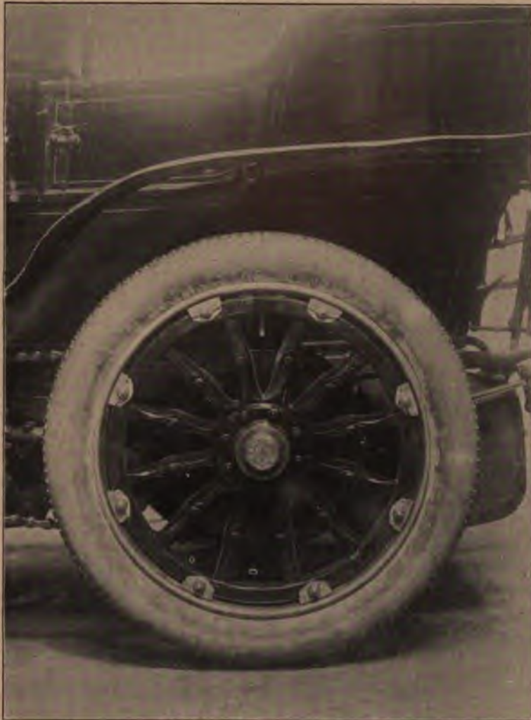
Abb. 119. Pneumatik mit abnehmbarer Felge, fertig am Wagen montiert.
