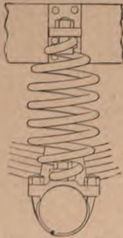
Abb. 51. Stoßdämpfer, bestehend aus einer Spiralfeder.
