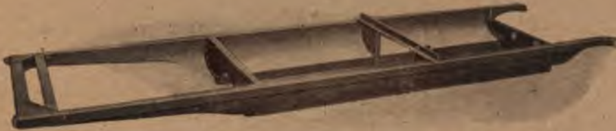
Abb. 34. Rahmen mit muldenförmig gepreßten Seitenträgern.
