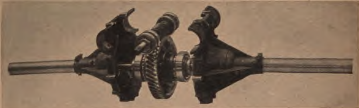
Abb. 23. Antrieb der Hinterachse durch Schnecke und Schneckenrad.
