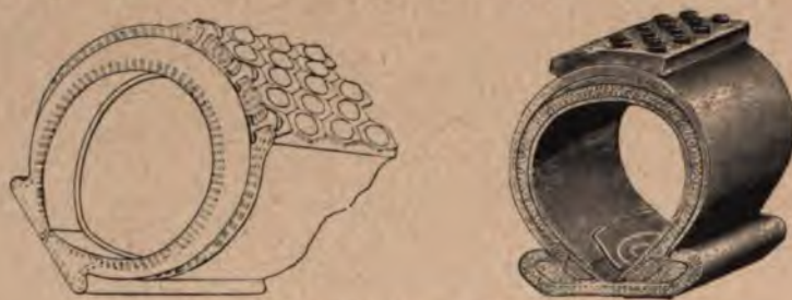
Abb. 109 und 110. Gleitschutzreifen mit Lederprotektor.
