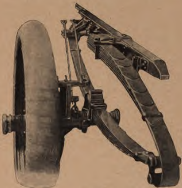
Abb. 49. Befestigung einer Dreiviertel-elliptikfeder an dem Rahmen und der Achse.
