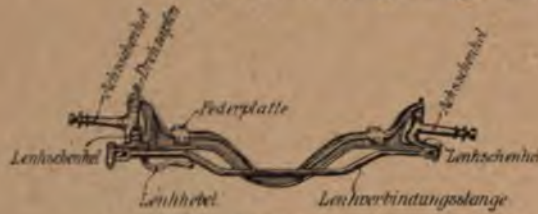
Abb. 64. Vorderachse mit Achsschenkelenkung und vor der Achse liegender Verbindungsstange.
