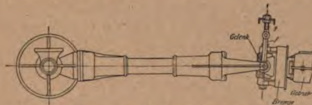
Abb. 83. Übertragung des Achsschubes auf den Rahmen durch das Gehäuse der Kardanwelle. (Ansicht.)
