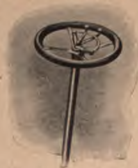
Abb. 61. Lenkrad mit Hebeleien für Zündung und Drosselung.
