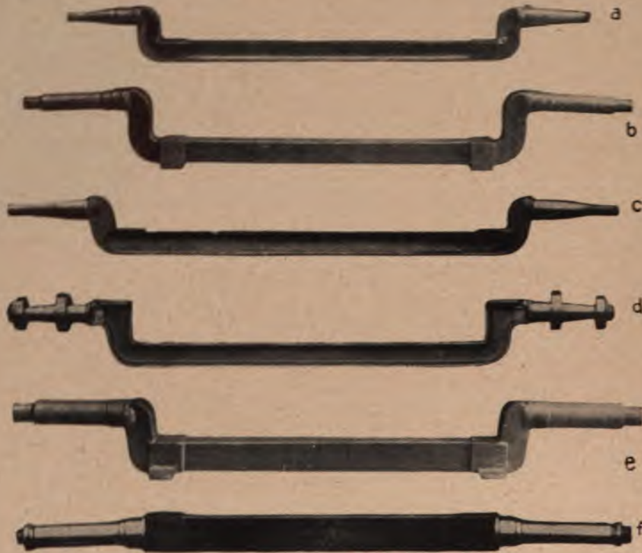
Abb. 72a-f. Einige Ausführungen von Hinterachsen für Kettenwagen. a, b, c, d Hinterachsen für Luxuswagen und leichte Geschäftswagen; e, f Hinterachsen für Lastwagen.
