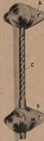
Abb. 57. Stoßdämpfer Edo, welcher durch Reibung die überschüssige Kraft verzehrt.
