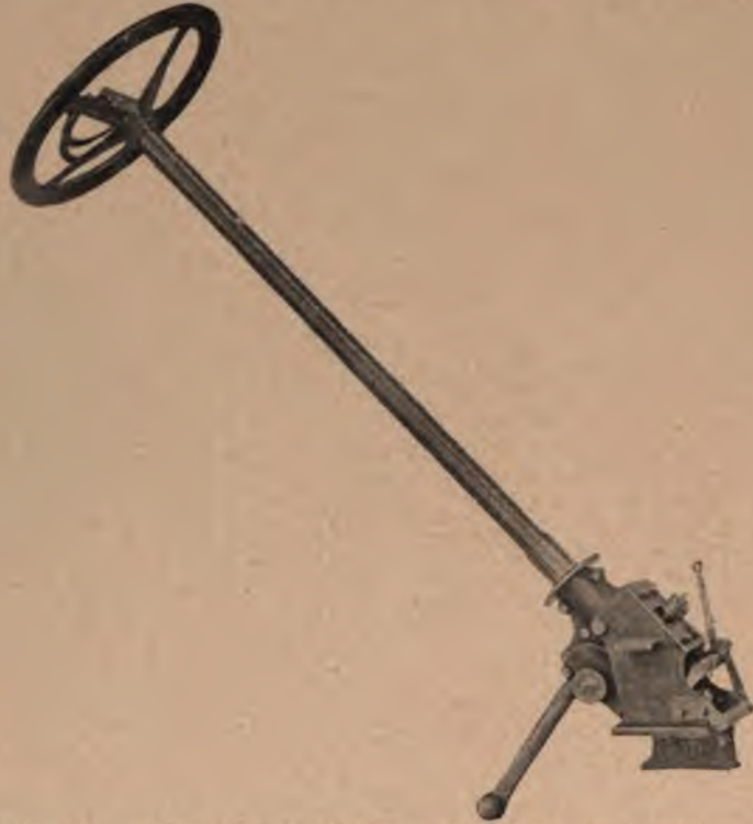
Abb. 60. Ansicht eines Lenkstockes mit Hebeleien zur Verstellung der Zündung und zur Drosselung des Gases.
