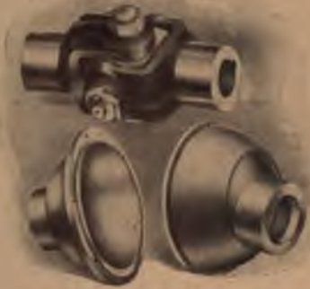
Abb. 74. Ein Kardangelenke und seine zweiteilige Schutzbüchse.
