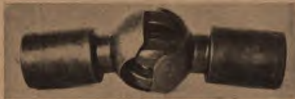
Abb. 18b. Dasselbe Gelenk zusammengesetzt.
