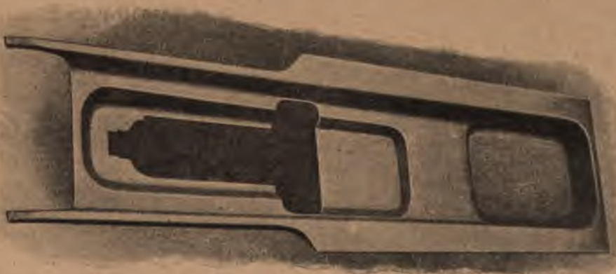
Abb. 35. Panzerrahmen, bei welchem der Rahmen aus einem Stück Blech gepreßt ist.
