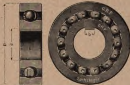
Abb. 95. Kugellager mit Kugelkäfig.
