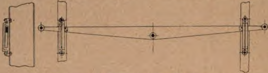
Abb. 89. Bremsausgleich durch eine Wage.
