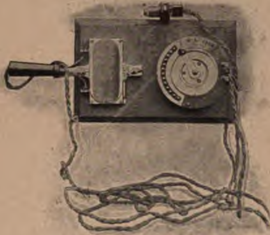
Abb. 125. Freys elektrischer Vulkanisier-Apparat.
