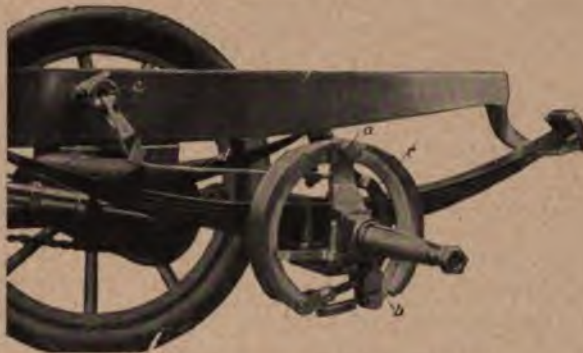
Abb. 88. Bremsausgleich durch Zugseil.
