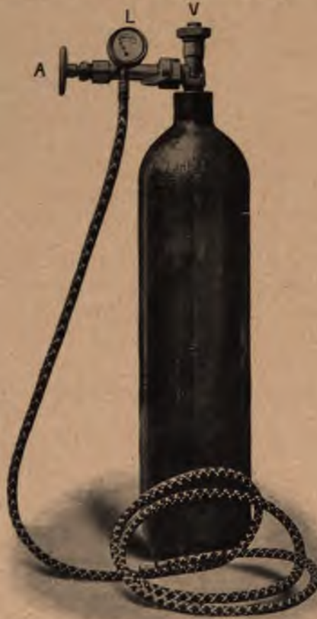
Abb. 130. Stahlflasche mit komprimierter Luft.
