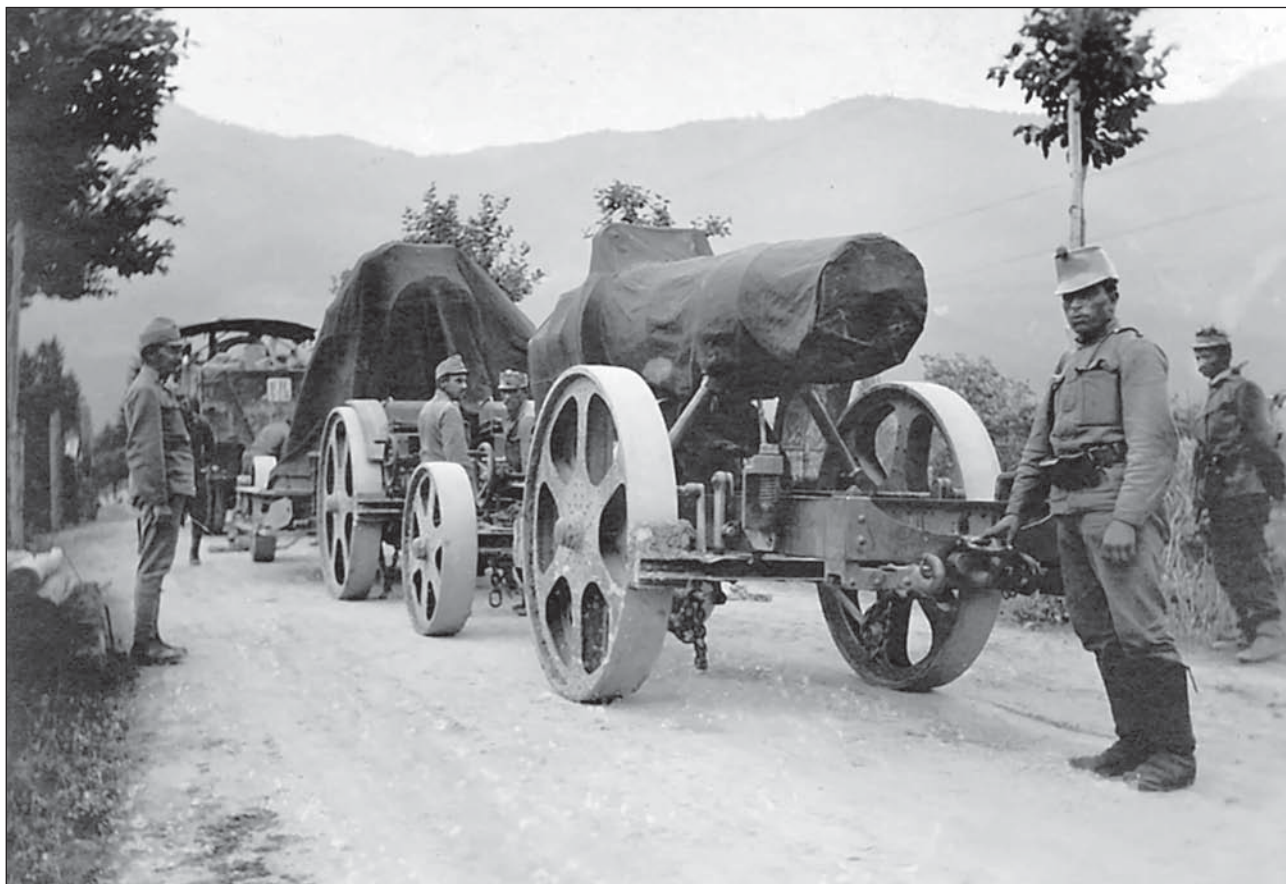
Лафет и ствол 305-мм мортиры, транспортируемые тягачом Austro-Daimler M.12
