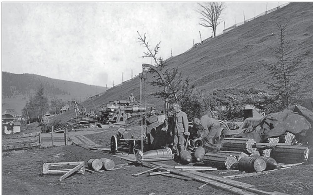
Снаряды извлекаются из восьмигранных деревянных ящиков и с помощью талей грузятся на снарядную тележку
