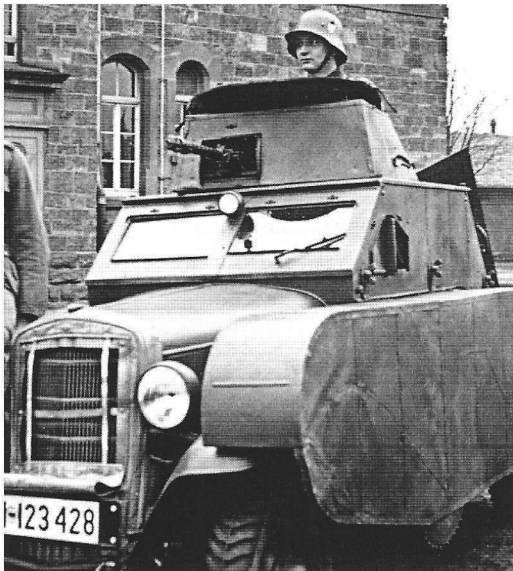
Die Anbringung des Maschinengewehrs an der Opel-Panzertrappe war relativ selten zu beobachten. Man beachte an diesem Fahrzeug auch den Winterschutz für den Kühler.
