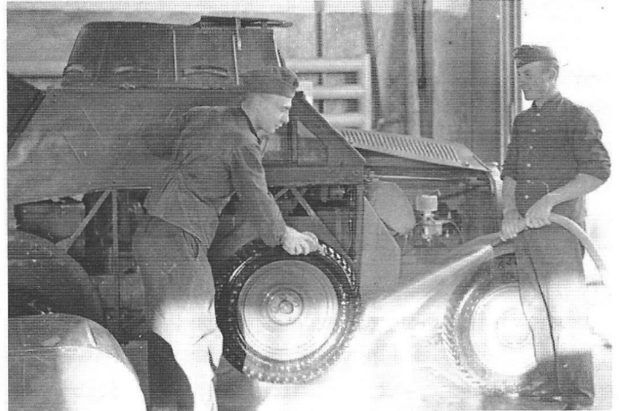
Die Ersatzradhalterung unter der rechten Panzerungsattrappe. The spare-wheel mount under the right side dummy armour. (JV)
