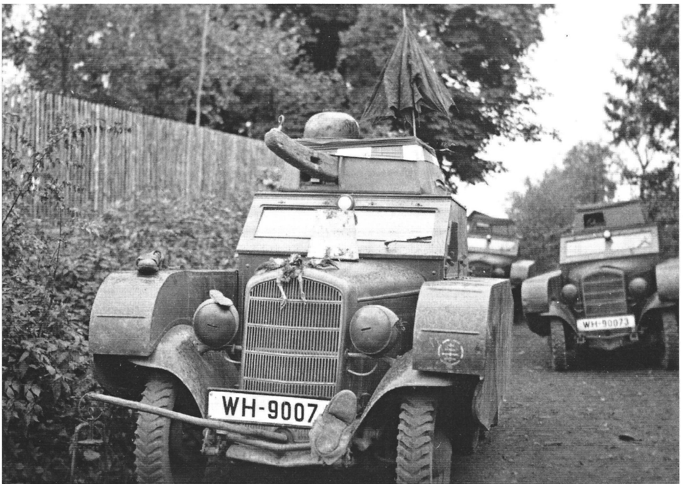
Eine sehr schöne Studie von Opel-Panzeratruppen im Manöver. Die Anbringung der Panzerungsattrappe auf der Karrosserie des Opel P4 ist gut zu erkennen. Die Besatzung dieses Fahrzeugs bestand aber sicherlich aus Spaßvögeln! Man beachte den Regenschirm und den Wassertopf als Regenschutz auf dem Turm, die "Notbeleuchtung" an einer Stange vorne aus dem Kühler, die extrem improvisierte "Bewaffnung" im Turm, die Schuhe von Passanten und schließlich das Vogelgerippe auf dem Kühler.
