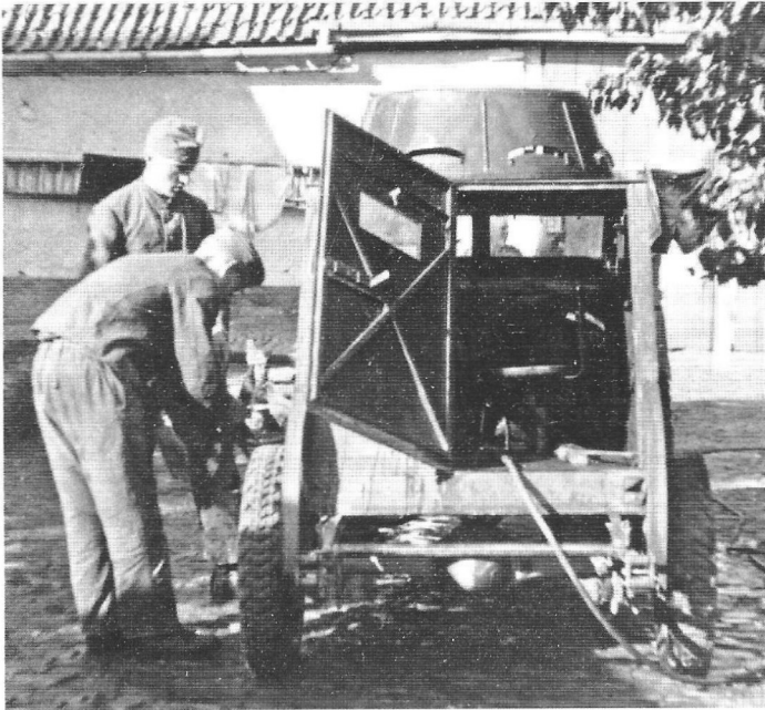
Heckansicht mit abgebauten Seitenteilen und geöffneter Heckklappe. Bei genauem Hinsehen fällt der einzelne Sitz des Kommandanten auf. Rear view with removed side parts and open rear door, unveiling the commanders station. (JV)
