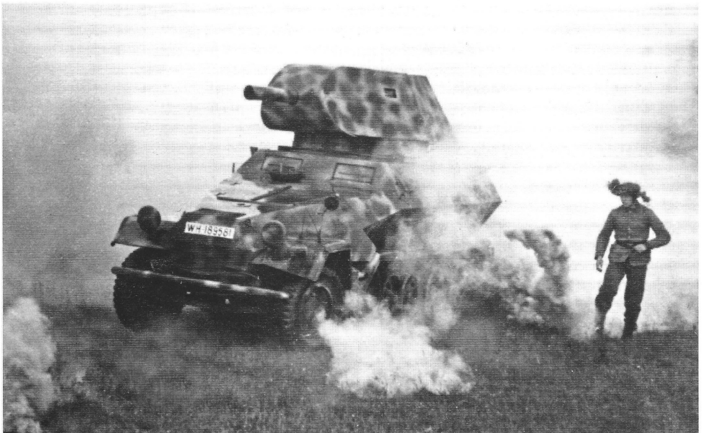
Die Wehrmacht nutzte während der Kriegsjahre zahlreiche, teilweise sehr aufwendig durchgeführte Umbauten, um Panzerattrappen für die Panzernahbekämpfung in realistischer Form zu gewinnen. Hier eine Attrappe eines sowjetischen Kampfpanzers T-34 (siehe Holzturm) motorisiert auf einer Halbkette Sd.Kfz. 251 Ausführung A, noch mit ungepanzerten Sehklappen.
