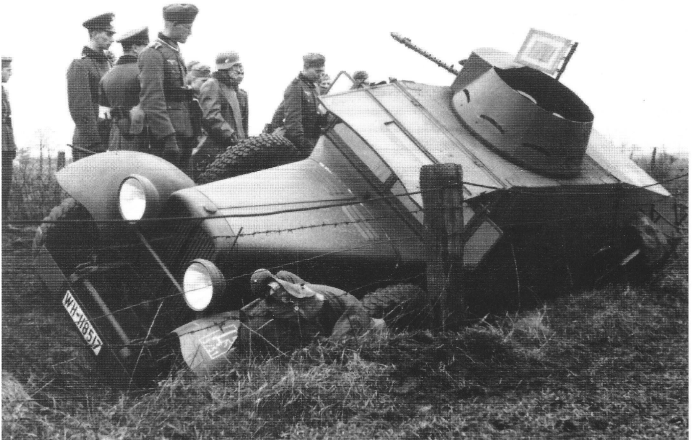
Eine weitere Attrappe, auch hier möglicherweise ein Unikat, ist diese Panzeratrappe auf Stoewer M12. Das Fahrzeug, wie auch beim Adler oben, hat keine Kettenatrappe. Es gehörte zur 3. (Fu)Kp Korps-Nachr. Abt. 51. Die Aufnahme stammt aus der Vorkriegszeit. Another improvised dummy, presumably also a unique vehicle, is this Panzeratrappe on Stoewer M12. This vehicle, as the one above, has not track-dummy. It belongs to 3. (Fu)Kp Korps-Nachr. Abt. 51. The picture dates before the war. (AA via HH)
