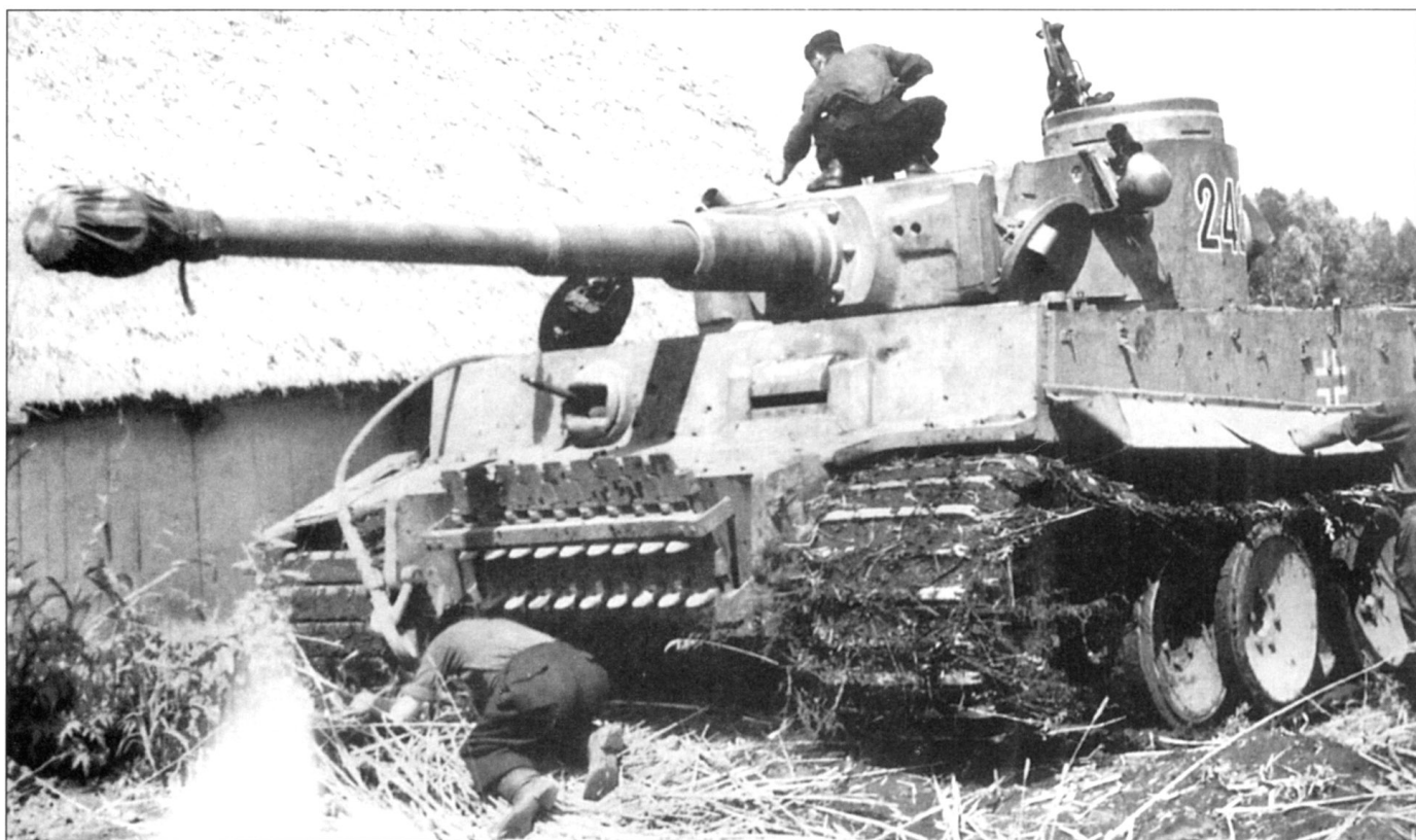
Техническое обслуживание «Тигра» из 4-го взвода 2-й роты 503-го тяжелого танкового батальона на остановке в длительном марше, район Белгорода, август 1943 г. На снимке хорошо виден способ крепления запасных гусеничных траков с помощью двух полос. Левый передний подкрылок оторван совсем, а передняя секция крыла отогнута. На борту башины рядом с дымовыми гранатометами видна отметина от противотанкового снаряда.
