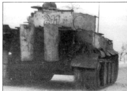
Снимок танка с бортовым номером «211» сделан с брони «Тигра» с тактическим номером «111». Номер написан прямо поверх временной зимней окраски на башенном коробе, получившем прозвище Rommelkiste. Обычно в левой части кормового бронелиста танков 2-й роты крепились канистры.
