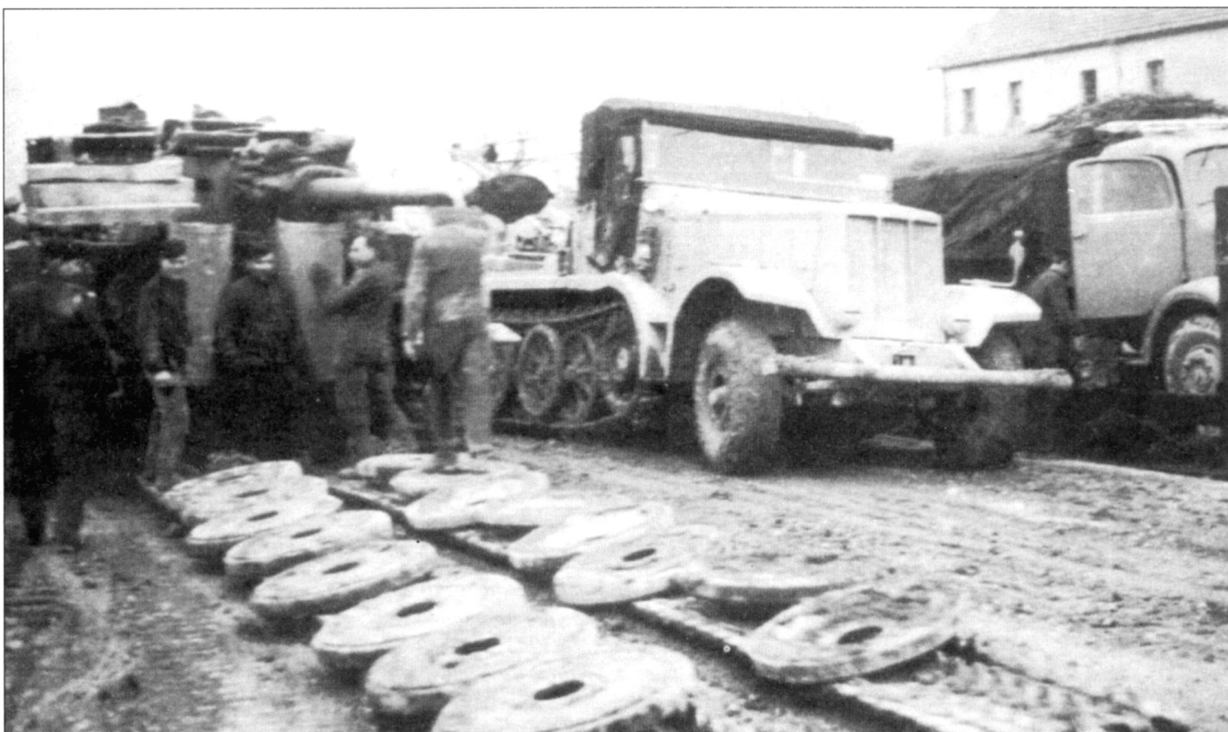
Оснащенные кранами грузоподъемностью 6 т 18-тонные тягачи SdKfz 9/1 состояли на вооружении тяжелых танковых батальонов, где их привлекали для ремонта и эвакуации «Тигров». Снимок сделан в декабре 1943 г. в Мэйлли ле Камп.
