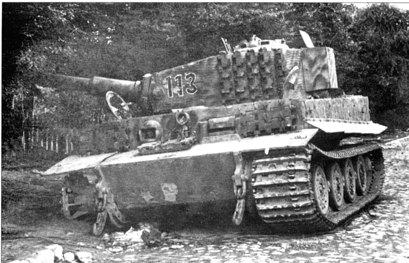
Подбитый в Звизнице Р-Крфв. VI Tiger Ausf. E позднего выпуска из 1-го взвода 1-й роты 506-го тяжелого танкового батальона. Машину с бортовым номером «113» удалось отбуксировать в тыл и отремонтировать. Обратите внимание на закрепленные на лобовом бронелисте С-образные крюки для буксировки.
