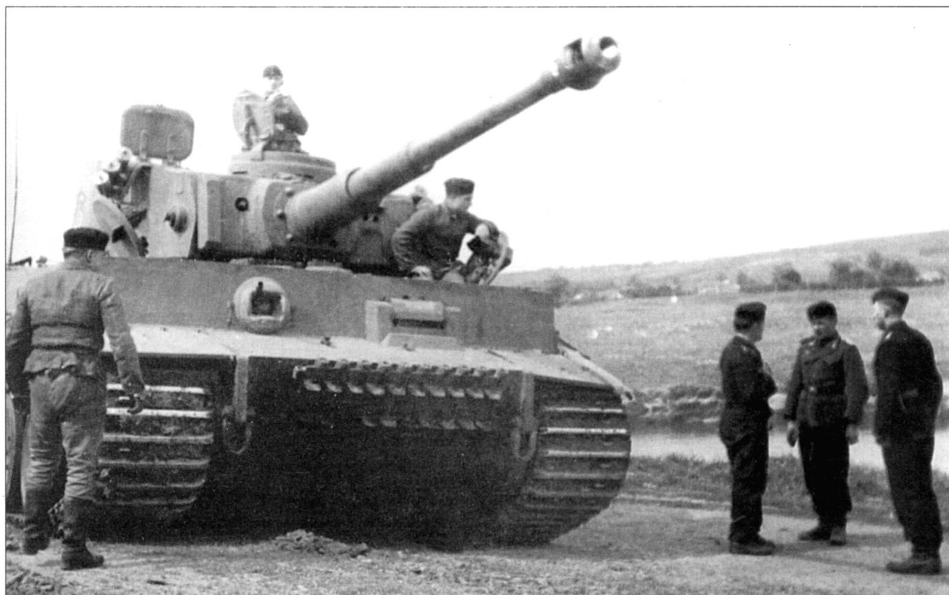
«Тигр» раннего выпуска. У механика-водителя установлен эпикоп ККФ-2 (видны два круглых отверстия в лобовом бронелисте надстройке корпуса над сдвижным бронещитком). Трубы дымовых гранатометов закрыты заглушками.
