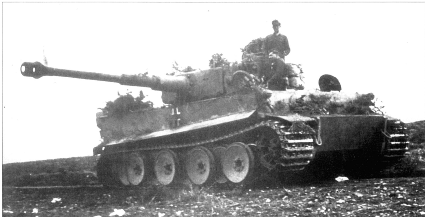
В качестве маскировки Pz.Kpfw. VI Tiger Ausf. E «африканской» модели использованы ветки кустарника. Танк принадлежит 501-му тяжелому танковому батальону, Тунис, зима 1943 г. На корме корпуса установлены фильтры Feifel.
