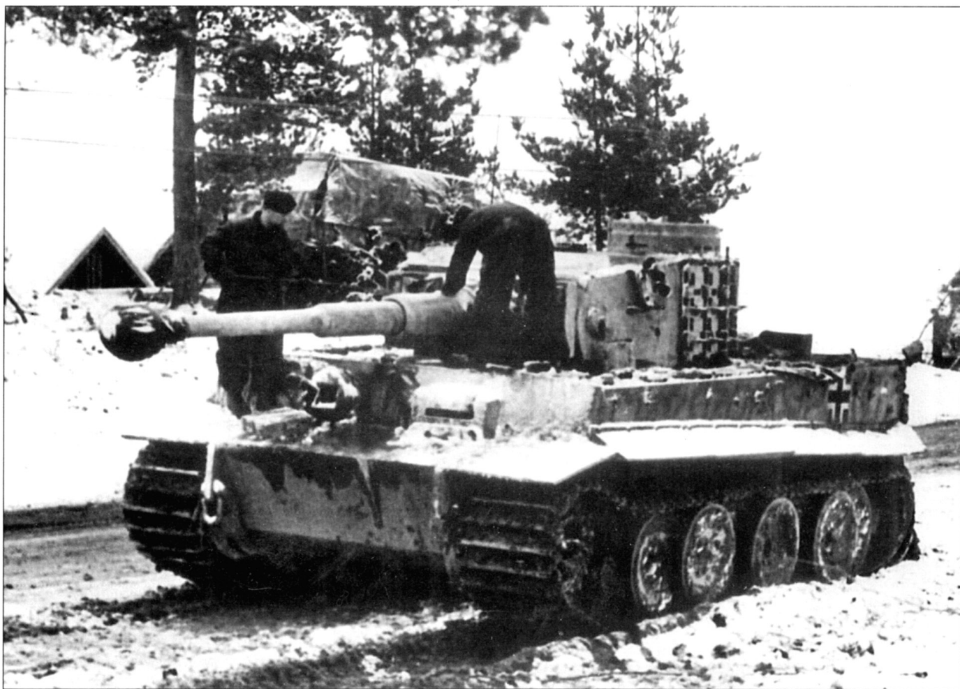
Рз.Крфв. VI Tiger Ausf. H1 раннего выпуска (на башне установлены дымовые гранатометы), Россия, зима 1943 г., подразделение не установлено. Защита бортов башни усилена гусеничными траками.
