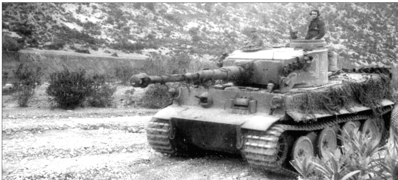
По бортам корпуса танка «Тигр» с бортовым номером «142» закреплены маскировочные сети.
