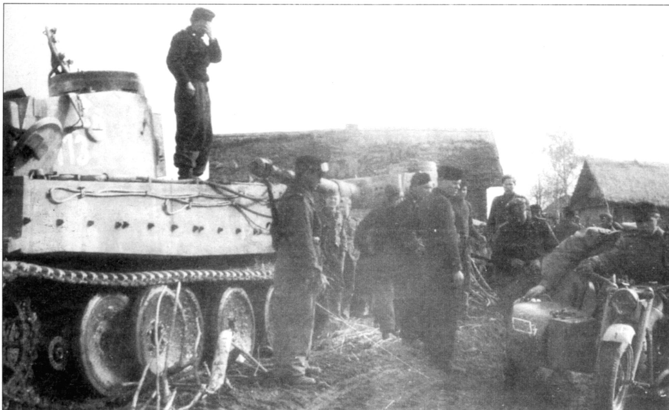
Тот же самый танк «З»- «14»- «113». Снимок сделан в небольшой российской деревушке, в которой местного населения уже не осталось. В начале весны 1943 г. все «Тигры» 502-го тяжелого танкового батальона перекрасили в песочно-желтый цвет. Одновременно изменили тактические номера, так номер «З» изменили на «14». На бортах корпуса появились болты для крепления секций крыла, однако самих секций в батальон так и не доставили.
