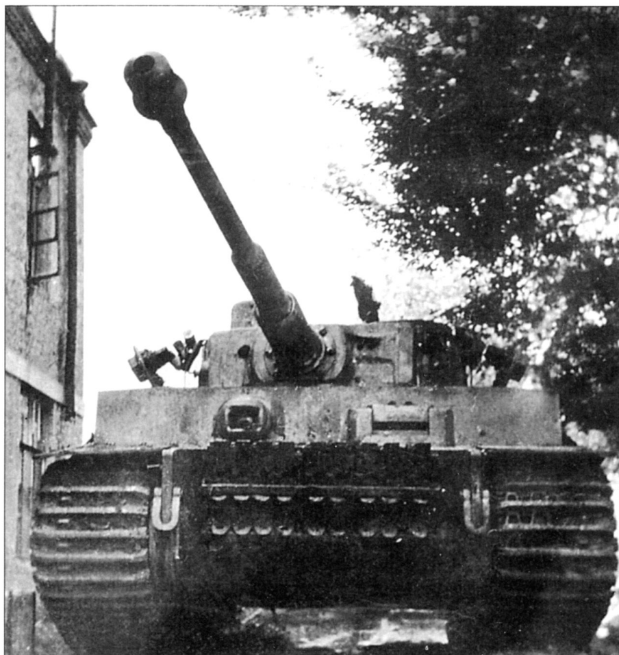
Рз.Крфв. VI Tiger Ausf. H1 раннего выпуска (на башне установлены дымовые гранатометы), Россия, зима 1943 г., подразделение не установлено. Защита бортов башни усилена гусеничными траками.
