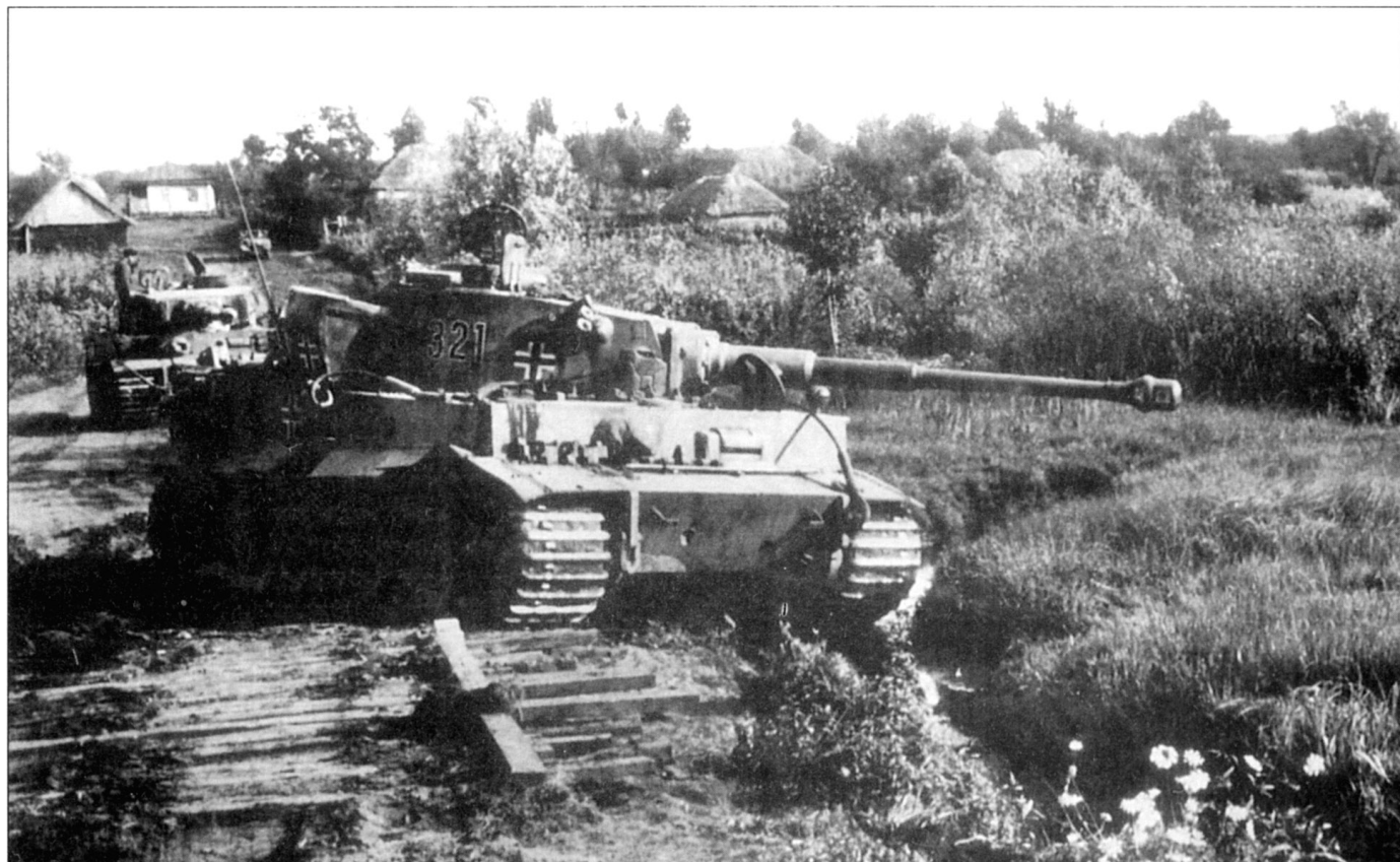
Рз.Крфв. VI Tiger Ausf. H1 командира 2-го взвода 1-й роты 503-го тяжелого танкового батальона, Россия, лето 1943 г. Кресты с бортов башни исчезли очень быстро - они оказались хорошими прицельными метками для наводчиков противотанковых орудий противника. На этом «Тигре» башенные кресты еще не покрашены.
