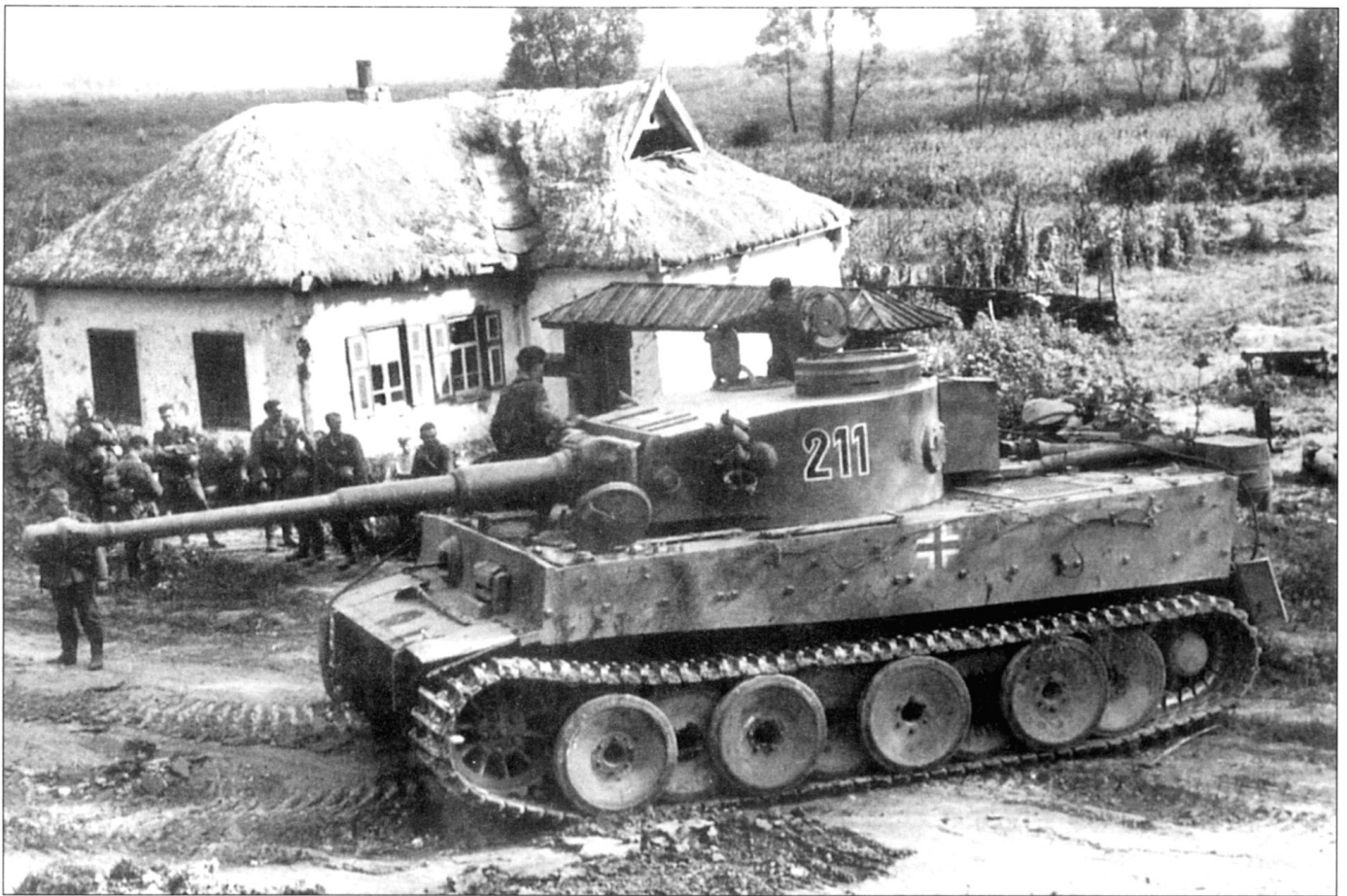
Рз.Крфв. VI Tiger Ausf. H1 раннего выпуска командира 1-го взвода 2-й роты 503-го тяжелого танкового батальона, 1 августа 1943 г., район Белгорода. Обратите внимание на полный комплект фильтров Feifel - редкость для этого периода.
