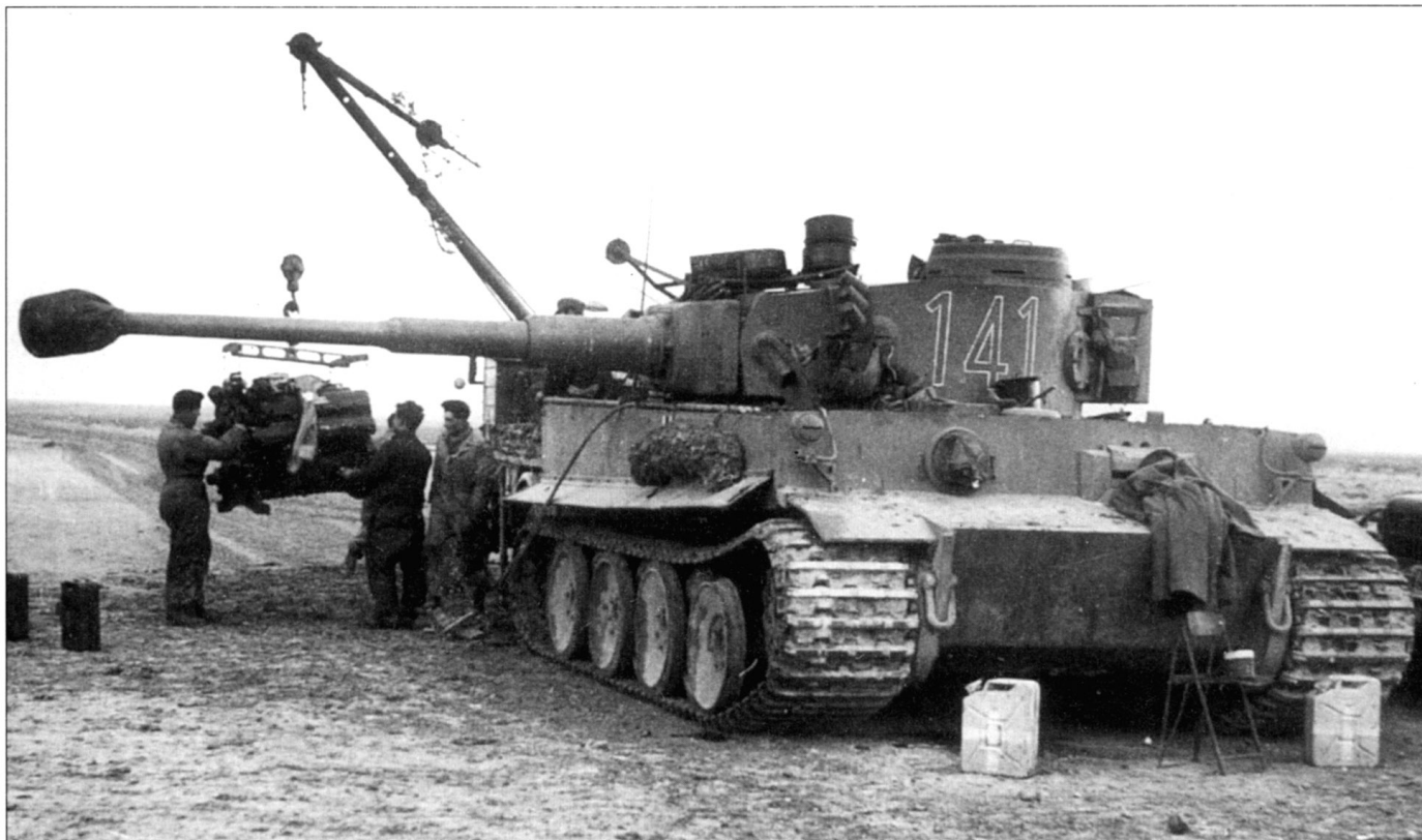
Замена двигателя на танке «Тигр» в полевых условиях представляла собой большую проблему из-за значительных массы и размеров мотора. Справа виден капот трофейного американского автомобиля Додж.
