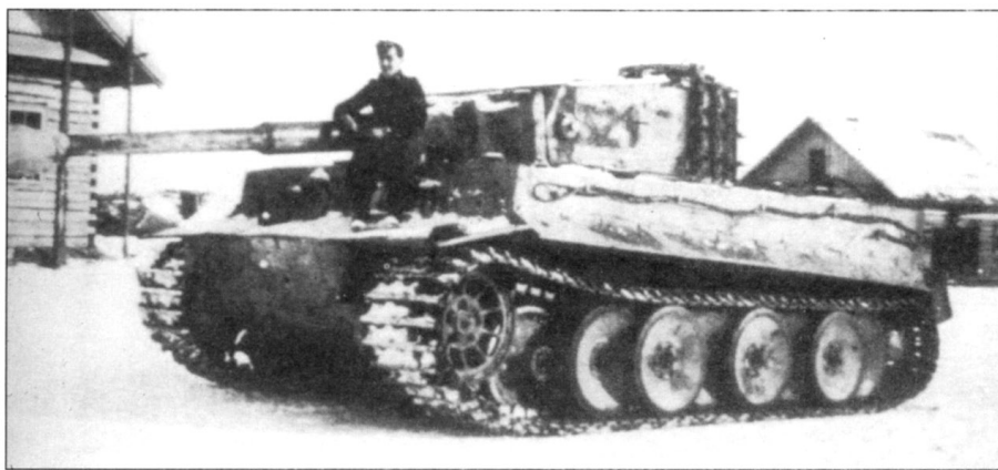
Танк «Тигр» с бортовым номером «321», на машине отсутствует передний внешний опорный каток левого борта. В период оттепели грязь часто набивалась между опорными катками, при понижении температуры она замерзала, и танк лишался подвижности.
