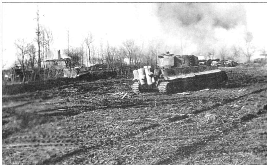
Американцы позируют на сгоревшем «Тигре» из 1-й роты 504-го тяжелого танкового батальона. Внутренним взрывом сорвана крыша башни.
