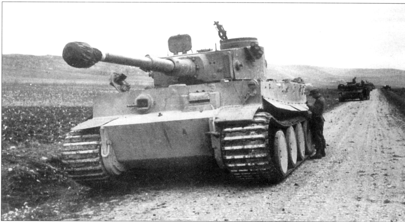
Колонна танков Pz.Kpfw. VI Tiger Ausf. H1 «африканской модели» раннего выпуска. Танки остановились на осмотр, Тунис, весна 1943 г. Обратите внимание на узкие передние подкрылки, перенесенную на лобовой лист надстройки корпуса фару, епископ KKF-2 механика-водителя. На маске орудия (ниже отверстий под оптический прицел) видны следы от попадания снарядов. На заднем плане стоит танк Pz.Kpfw. III, за ним - снова «Тигры».
