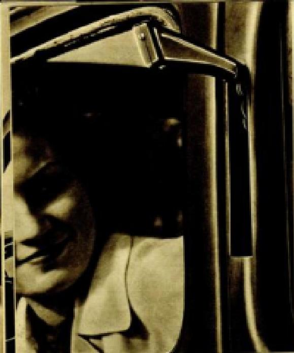
Die Winker sind an der besten Stelle in die Karosserie eingeklinkt und herausgestellt für jeden Verkehrsteilnehmer gut sichtbar. Selbst bei starkem Gegenwind arbeiten sie durch die starken Magnete und ihr Eigengewicht einwandfrei.
