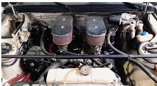
Sopra, la 305 Gr. B a trazione posteriore. A sinistra, il suo motore V6 di 2,5 litri, montato in posizione anteriore. Sotto, la concept-car Quasar con motore biturbo posteriore.
