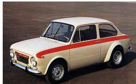
**OT 1600 "Mostro".** Ottobre 1964, 1592 cc, 155 CV, 220 km/h (provato anche motore 2000).
