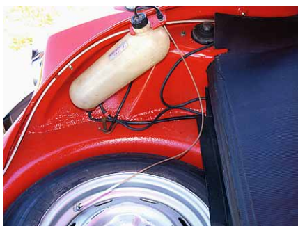
Nel vano anteriore sono presenti anche la vaschetta del liquido freni (a sinistra) e il serbatoio del lavacrystalli. Quest'ultimo è tenuto in pressione dall'aria della ruota di scorta (a destra). Motivo in più per verificare periodicamente la pressione del pneumatico.
