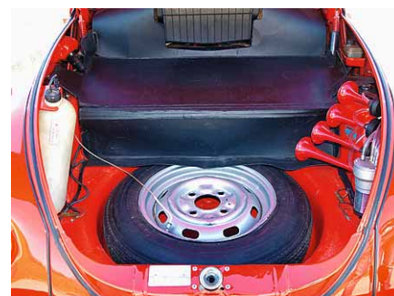
La ruota di scorta si trova sotto il piano di carico, al pari del serbatoio carburante. Gli avvisatori acustici a tromba sono un accessorio after-market.
