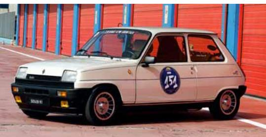
Nel 1982 il testimone passa alla R5 Alpine turbo Coupe, che grazie all'adozione di una turbina Garrett T3 (senza intercooler) vede la cavalleria salire a 110 CV sulla vettura stradale per
