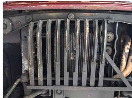
Sopra, a sinistra, l'accensione è a spinterogeno, a fianco ci sono la bobina e la batteria; al centro, vista inferiore del serbatoio della benzina, che è dotato di tappo di scarico; infine, a destra, la coppa dell'olio è protetta da una griglia, accessorio after-market piuttosto diffuso all'epoca.
