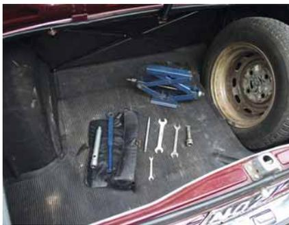
Sopra, il bagagliaio come in molte berline dell'epoca è in parte occupato dalla ruota di scorta. Abbondante la dotazione di attrezzi. Nella trasparenza del motore si possono
