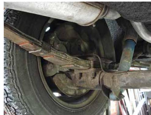
Sopra, a sinistra il gruppo cambio-differenziale e del telaio ausiliario che sostiene il motore; al centro l'avantreno a ruote indipendenti, con trapezi oscillanti, ammortizzatori e barra stabilizzatrice; a destra, il retrotreno ad assale rigido con balestre longitudinali.
