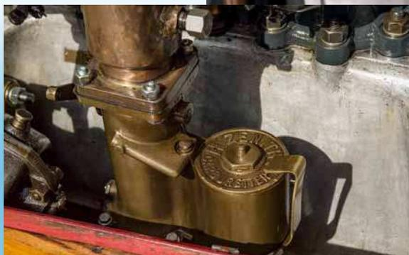
hanno una gradazione relativamente "calda" e il piccolo rubinetto per il "cicchetto" pre avviamento. Qui sopra, il carburatore Zenith. Le leve esterne della S 61 comandano freno a tamburo e cambio. In alto, il motore è bi-blocco (cilindri accoppiati a due a due.)
