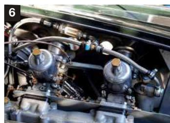
speciale; il ponte rigido posteriore (2), con balestre più rigide; il radiatore olio (3) aggiunto nella fiancata destra; il serbatoio antiesplorazione da 50 litri (4); il radiatore acqua maggiorato, in alluminio (5); i carburatori SU H4 monocorpo (6); il sei cilindri inglese (7) dopo la preparazione eroga 145 CV.
