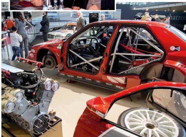
Sopra a sinistra, una Mercedes 230 SL in lavorazione presso Astaller Classic: tantissimi gli specialisti delle Case tedesche. Sopra a destra, nello stand della Mecatronik faceva bella mostra di sé questa Alfa Romeo 155 DTM di cui erano messi in mostra tutte le componenti, a partire dal V6 2.5 da 450 CV.
