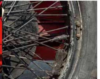
benzina super a 100 ottano... Qui a fianco, una ruota posteriore: dietro il cerchio si vedono la trasmissione a catena e il freno a tamburo. L'impianto frenante è soltanto al retrotreno. Sopra, un dettaglio del cerchio con i pesi dell'equilibratura e la chiusura con i bulloni. I cerchi in origine erano di legno, questi sono successivi, della Rudge&Whitworth.
