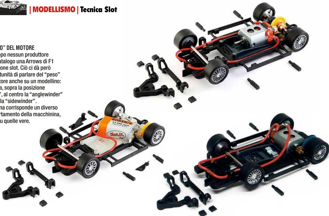
**POSIZIONE DEL MOTORE E DINAMICA DEL TELAI**
