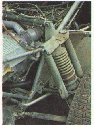
Уникальная раллийная «Лянча-Дельта-С4» (три верхних фото) похожа на закамуфлированный легкими кузовными панелями автомобиль гоночной формулы с приводом на все колеса.
