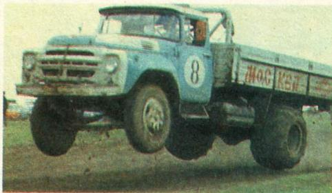
Кроссовый ЗИЛ, оснащенный арочными шинами.
