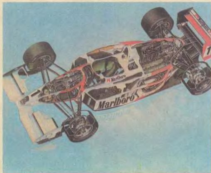
«Рейнард-92-КосвортDFV» — лучшая машина чемпионата (V-8, 2994 см 3 , 450 л. с., 530 кг, конструктор Малколм Оустлер).
