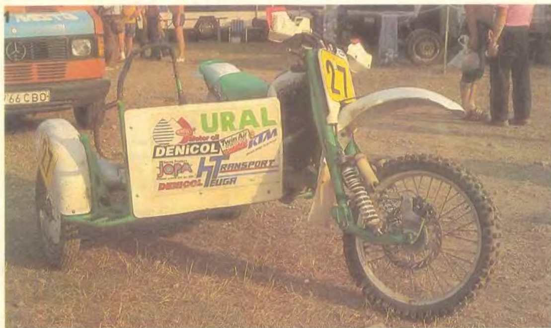
1. Кроссовый «Урал», на котором выступают Сергей Щербинин и Сергей Зырянов, оснащен двигателем KTM с рабочим объемом 640 см 3 . Максимальная мощность мотора 72 л. с. (5600 об/мин), максимальный крутящий момент — 8,9 кгс·м (4900 об/мин).
