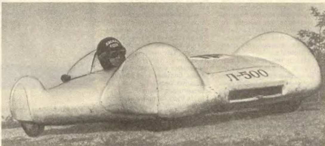
"Харьков-Л1", переделанный в 1961 году Ильей Тихомировым в газотурбинный автомобиль "Пионер-2".
