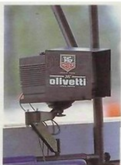
Информация от расположенных вдоль трассы фотоэлементов поступает на мониторы в боксах команд (вверху), на пункт управления гонкой, где находится главный судья (стр. 19, вверху), и на переносные мониторы для каждого из пилотов.
