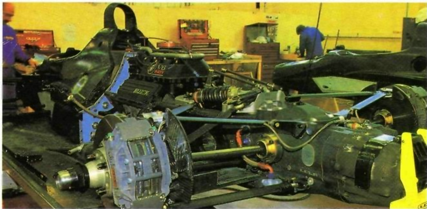
Коробка передач «индикара» расположена не впереди, как у «формулы», а позади ведущей оси.
