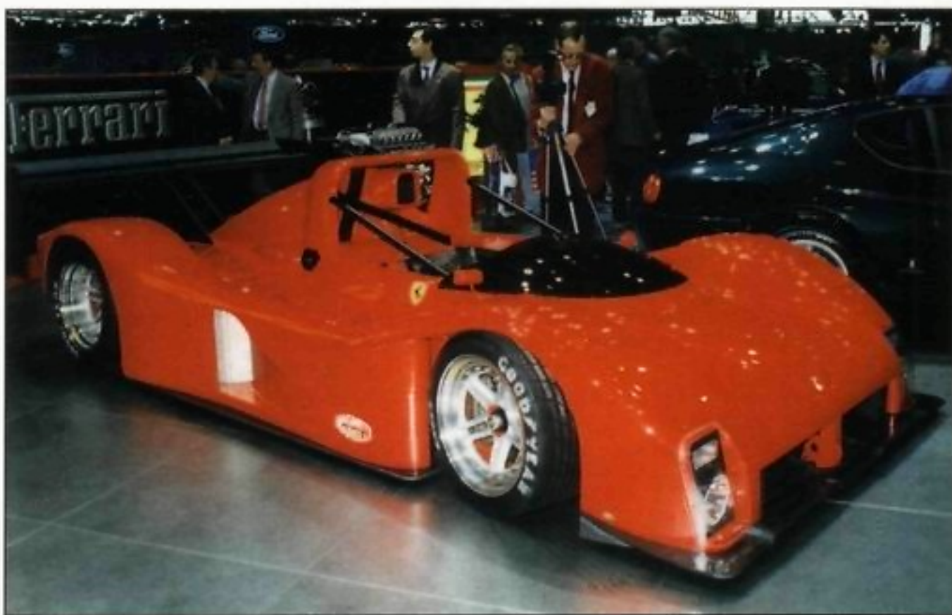
Инициаторы нового класса "Экссон Уорлд спорт кар" надеются в рамках чемпионата IMSA возродить былую славу Кан-Ама. На снимке А. Садовникова — спорт-прототип "Феррари-333SP" с 12-цилиндровым V-образным мотором (3997 см 3 , 600 л.с.). Во время своего дебюта в Атланте эти машины заняли первые три места.
