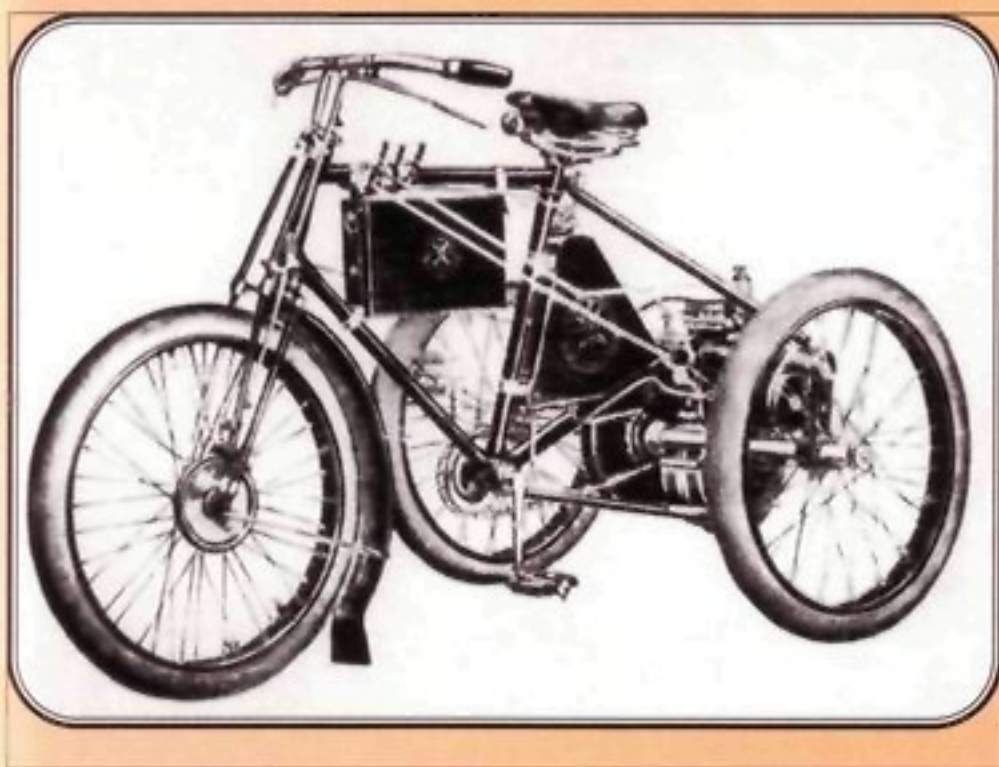
Трицикл "Де Дион-Бутон" образца 1896 года. Одноцилиндровый 4-тактный мотор воздушного охлаждения рабочим объемом 185 см 3 развивал всего 0,7 л. с. Тем не менее Виз удалось занять на такой машине третье место в абсолютном зачете гонки Париж—Марсель—Париж. Правда, мечтать о победе ему не приходилось — Французский автоклуб относил трехколесные машины де Диона к категории мотоциклов.
