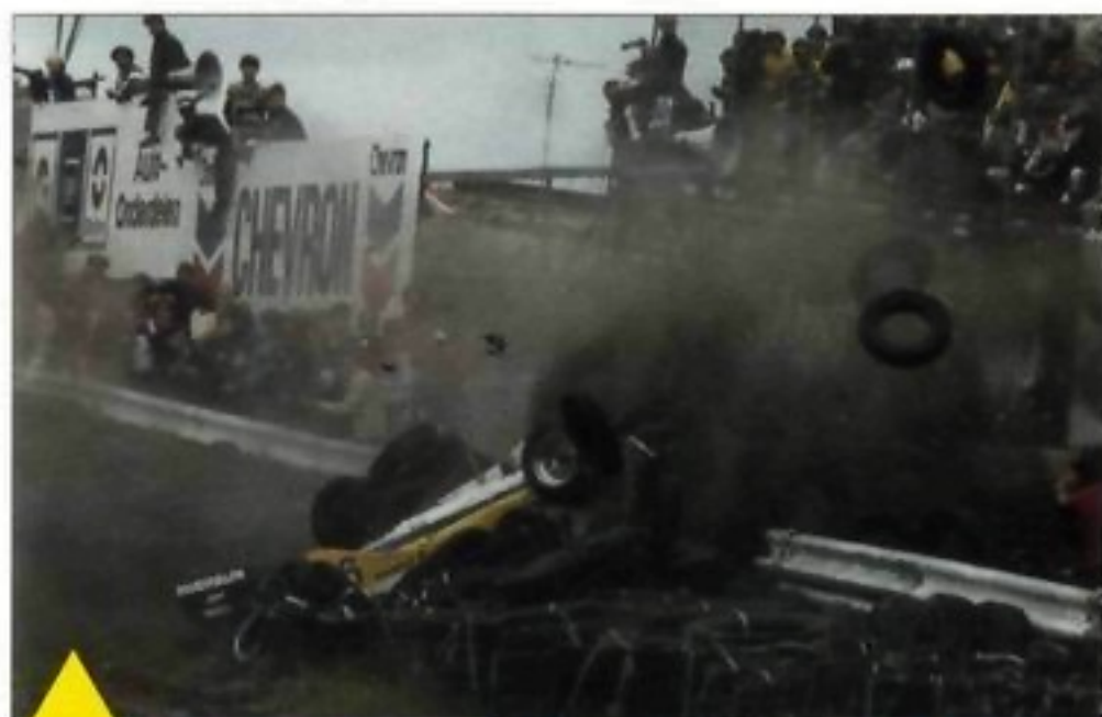
Вместо соломы еще в 60-е годы стали использовать отслужившие свой срок покрышки, оказавшиеся весьма эффективным "буфером". На снимке — авария Рене Арну на трассе в Зандфорте. На скорости в 300 км/ч перед поворотом его "Рено" потерял левое переднее колесо, однако сумев направить машину в резиновый барьер, француз отделался всего несколькими царапинами.
