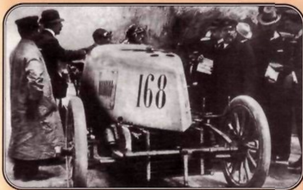
В неоконченной гонке Париж—Мадрид быстрее всех добрался до финиша первого этапа Фернан Габриэль. Его "Морс-Дофин" был оснащен 4-цилиндровым мотором мощностью 70 л. с. при 1200 об/мин и "аэродинамическим" металлическим кузовом. Максимальная скорость машины — 150 км/ч.
