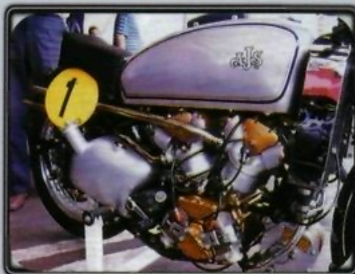
AJS с четырехцилиндровым V-образным двигателем.
