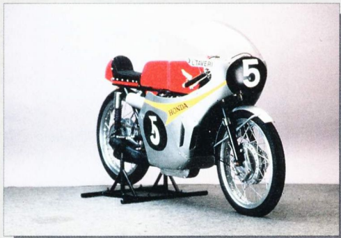
"Хонда-RC149" с пятицилиндровым 125-кубовым мотором.
