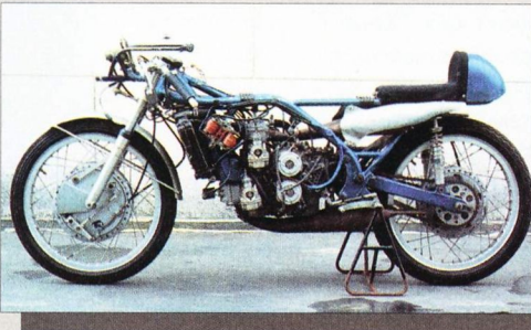
"Сузуки-RS67" с головоломной упаковкой четырех цилиндров.
