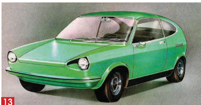
Prototype de VW dessiné chez Porsche. Le moteur est situé sous le siège arrière.
