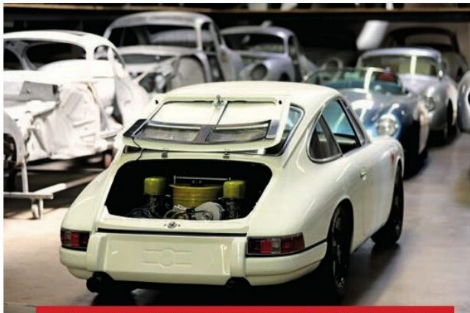
Construit sur la base d'un coupé de 1968, le projet Emory « 911 K » s'inspire des 908 K - notez la turbine de refroidissement plate.
