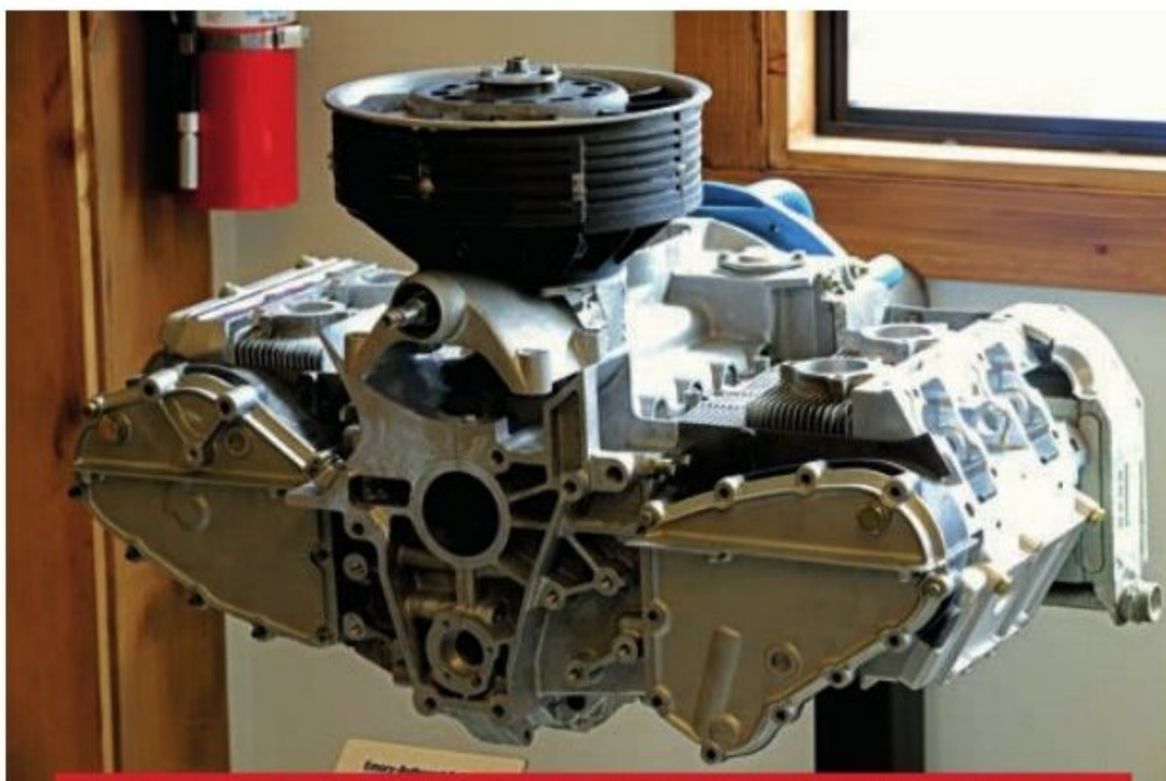
Le moteur Emory-Rothsport « Outlaw-4 » développe entre 205 chevaux (deux carburateurs) et 400 chevaux (double turbos).
