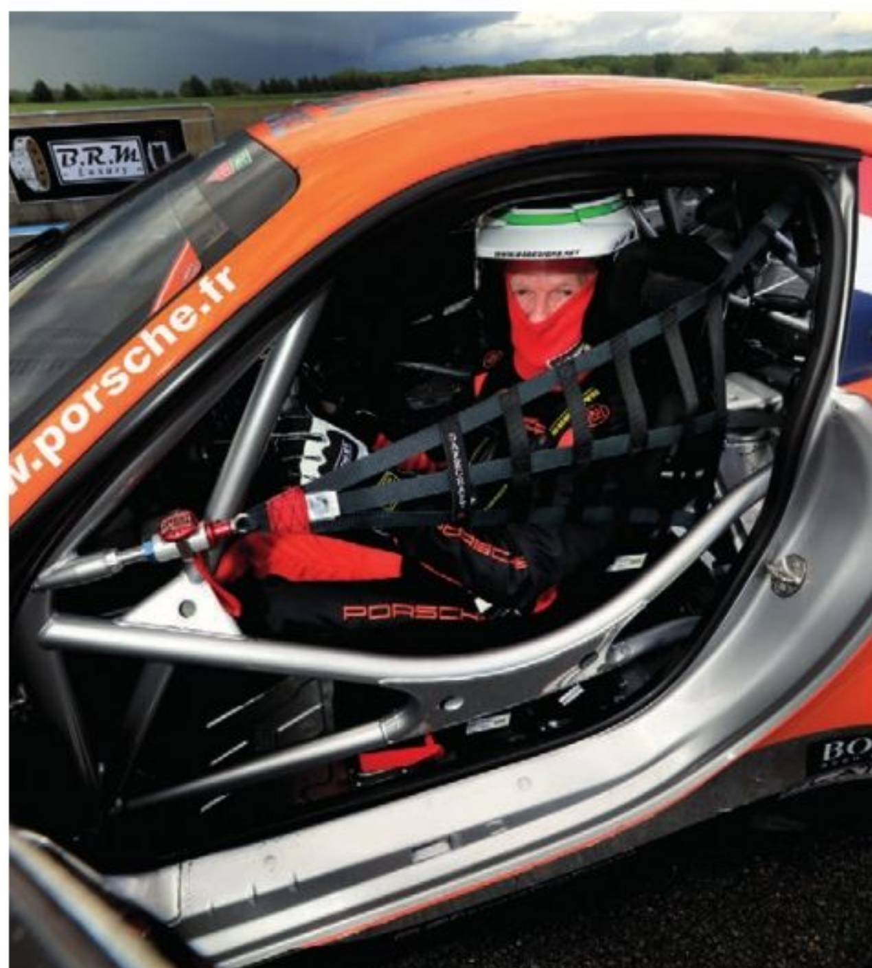
Les filets de protection entourent le pilote et servent à protéger ses bras en cas de retournement
