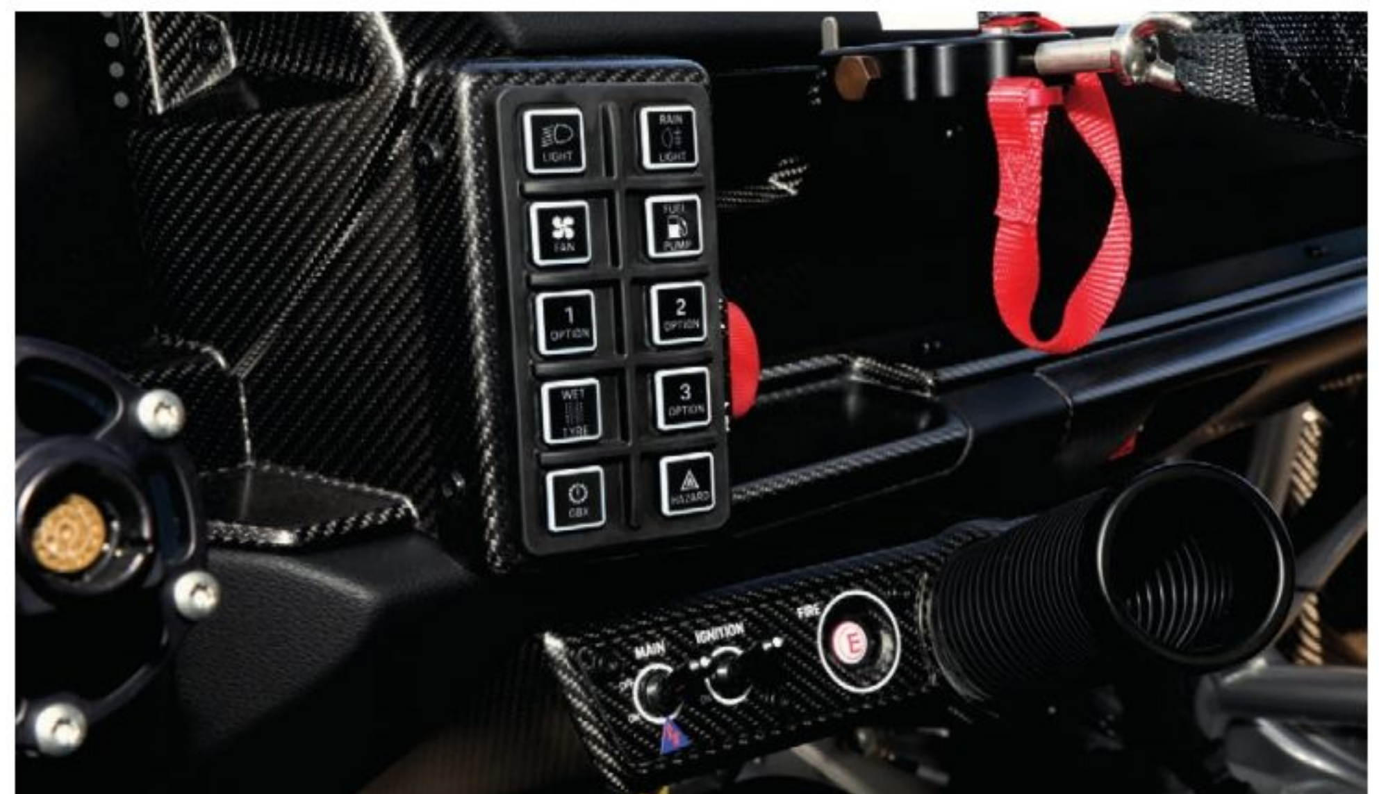
En bas à gauche se trouve le bouton permettant de mettre le wet mode (comme sur une Porsche de route, mais sans antipatinage !). En-dessous, le bouton GPX permet de débloquer la sécurité du régime moteur, en cas de problème d'utilisation de la boîte. A n'utiliser qu'en cas d'urgence, et avec précaution. Quant aux boutons d'options, ils permettent d'accéder à des modes différents selon le championnat qu'on dispute, Cup ou endurance, entre autres
