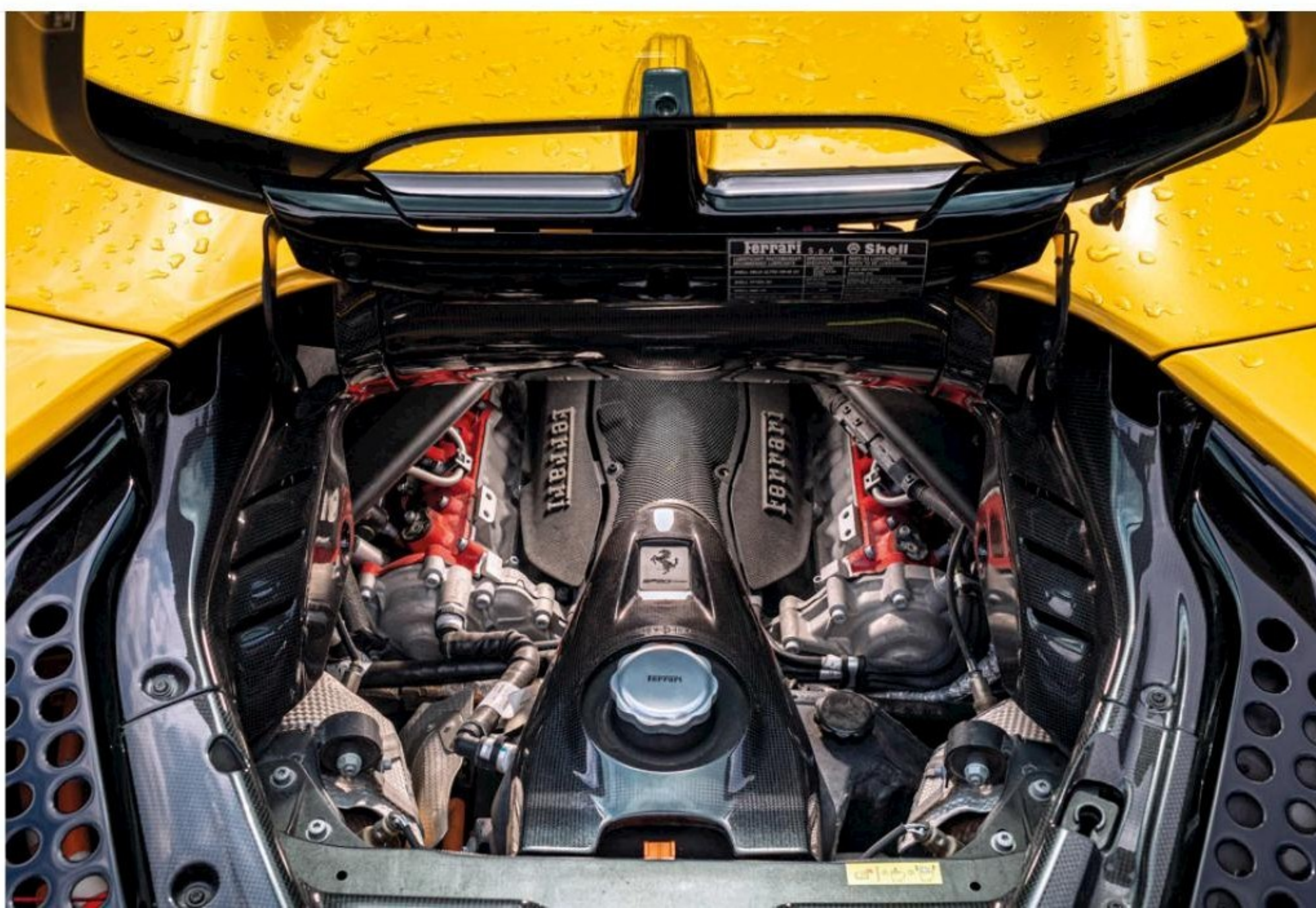
Tout au fond prend place au plus bas le V8 biturbo 4 litres de 780 ch. Au premier plan, entre le moteur et la boîte, s'immisce un petit électromoteur de 7 cm d'épaisseur.
