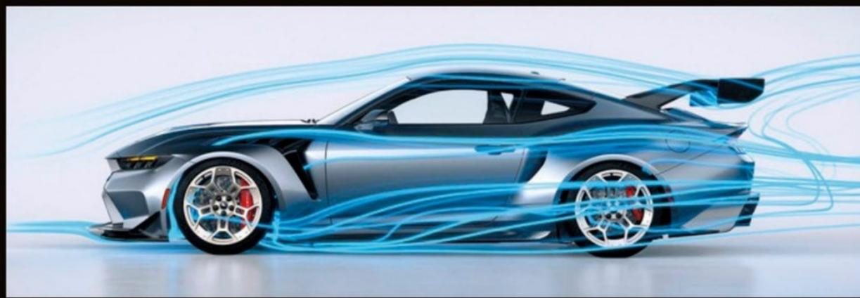
L'aéro active agit sur les volets avant et l'aileron.
