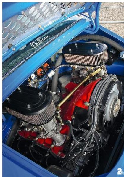
**2** Le compartiment moteur est rutilant, avec ses deux rampes de carbus PMO de 40.
