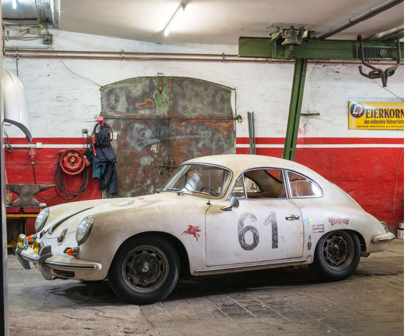
Alufelgen im Stahl-Look: Die pulverbeschichteten Tecnomagnesio in 5/205 bei 5J x 15 ET 24 fallen erst auf den zweiten Blick auf.
