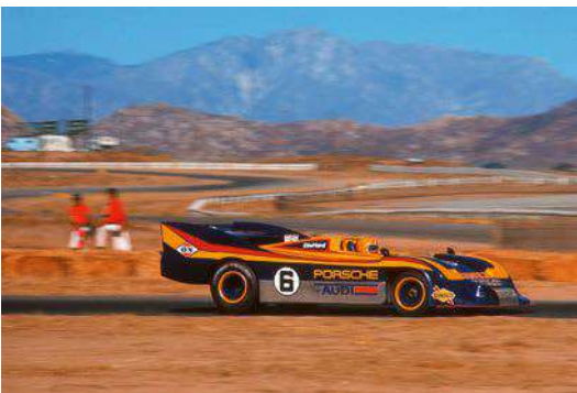
1973 In den USA schreibt Porsche die ersten Kapitel der Turbo-Erfolgsstory. Der 917/30 ist mit einem 1.200 PS starken 5,4-Liter-Zwölfzylinder unschlagbar.
