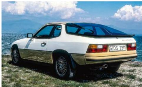
manutenzione sia da un punto di vista della guida, giacché il bilanciamento ottimale dei pesi ottenuto con lo schema transaxle rende la tenuta di strada sostanzialmente neutra nella grande maggioranza delle situazioni. Solo affrontando le curve veloci si manifesta un certo sottosterzo. Scarica a terra 170 cavalli: sono appena 10 in meno
