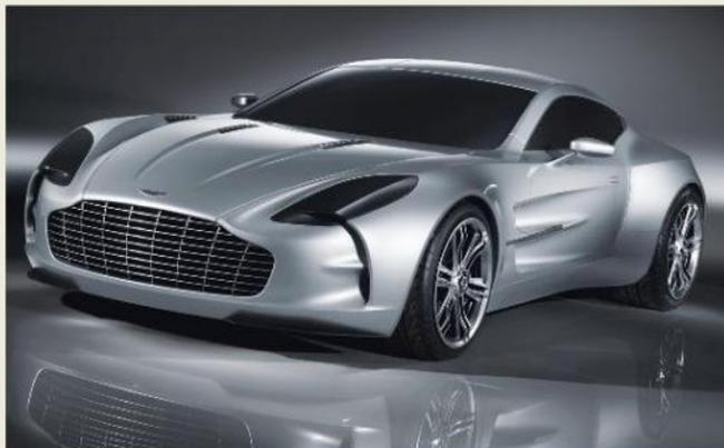
con monoscocca in carbonio e motore V12 di 7,3 litri (760 CV), capace di oltre 350 km/h di velocità massima.
