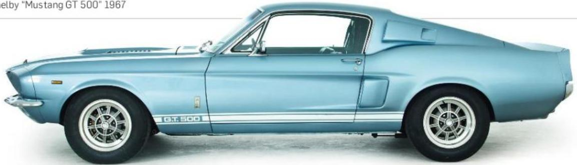
partendo da una "Fastback" con motore "289" di 4,7 litri da 271 CV, che lui porta a 306 e che nella versione da gara superano i 350. Le sospensioni anteriori vengono modificate nei punti di attacco, e per quelle posteriori si montano due puntoni di reazione per controllare i movimenti del ponte rigido durante le accelerazioni. Il sedile posteriore viene eliminato; al suo posto viene messa la ruota di scorta, a vantaggio della distribuzione dei pesi.
