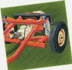
De achteras bestaat uit twee in de lengterichting in rubber ophangen versjarmen die door schroefveren aan het chassis zijn bevestigd.
