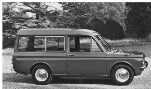
portellone posteriore, incernierato però nella parte superiore. La nuova versione si distingueva non solo per la sua forma squadrata, ma anche per la notevole altezza, dovuta alla necessità di mantenere un'elevata capacità di carico nonostante l'ingombro causato dal propulsore. Restò a listino fino al 1970 e non ebbe più un'erede.
