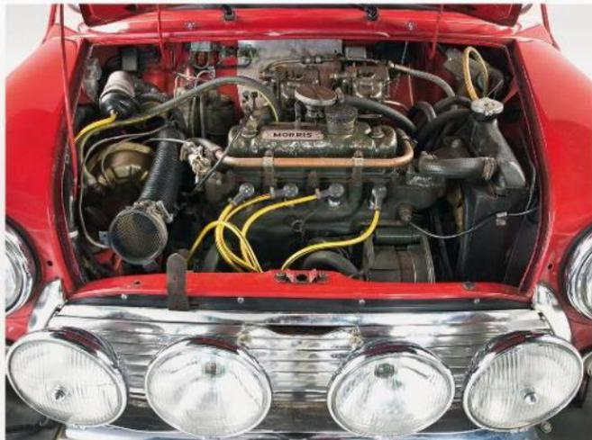
**Motore** Anteriore, trasversale - 4 cilindri in linea
