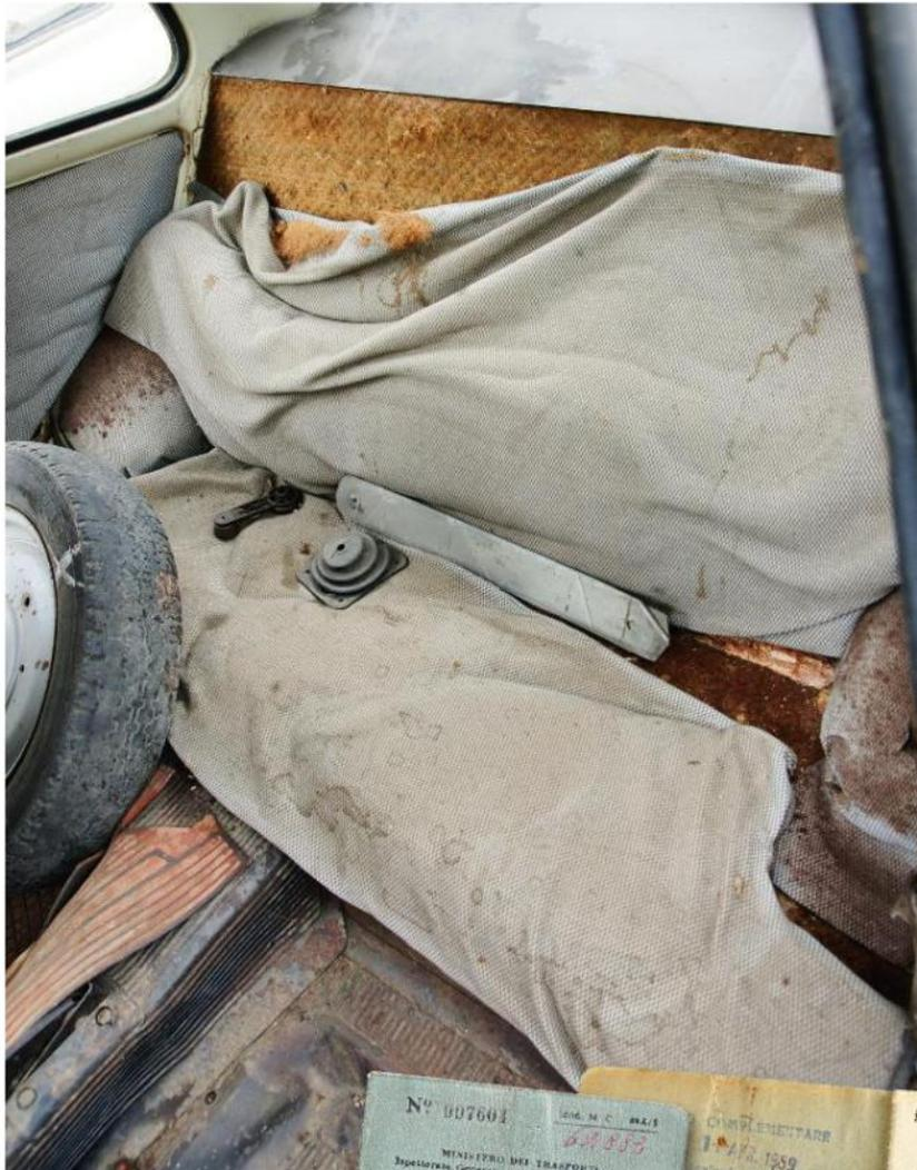
struttura propria ma seguiva il lamierato che divide l'abitacolo dal vano motore, è completamente sbriciolata. Mancano i pannelli originali delle portiere e il tappetino in gomma sul pavimento è irrecuperabile. L'unico strumento, che comprende tachimetro, contachilometri e spie, non è originale (è della "500 F"). Corrette invece le alette parasole in plastica stampata e le leve dell'avviamento e dello starter e con i pomelli tondi.
