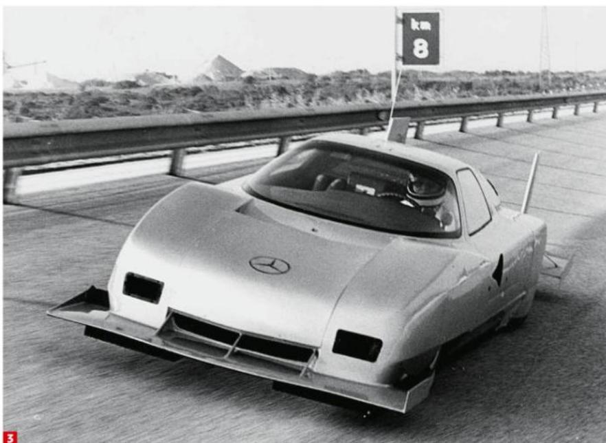
I tecnici tedeschi si resero subito conto che per vincere l'impegnativa sfida occorreva dotare la C111 di un motore a benzina; la scelta cadde sul V8 di 4,5 litri prelevato dalla produzione di serie, la cui cilindrata fu elevata a 4820 cm<sup>3</sup>. Altre modifiche significative riguardarono la nuova distribuzione a 48 valvole e l'adozione di due turbo KKK; la potenza ottenuta raggiunse i 500 CV. A livello
