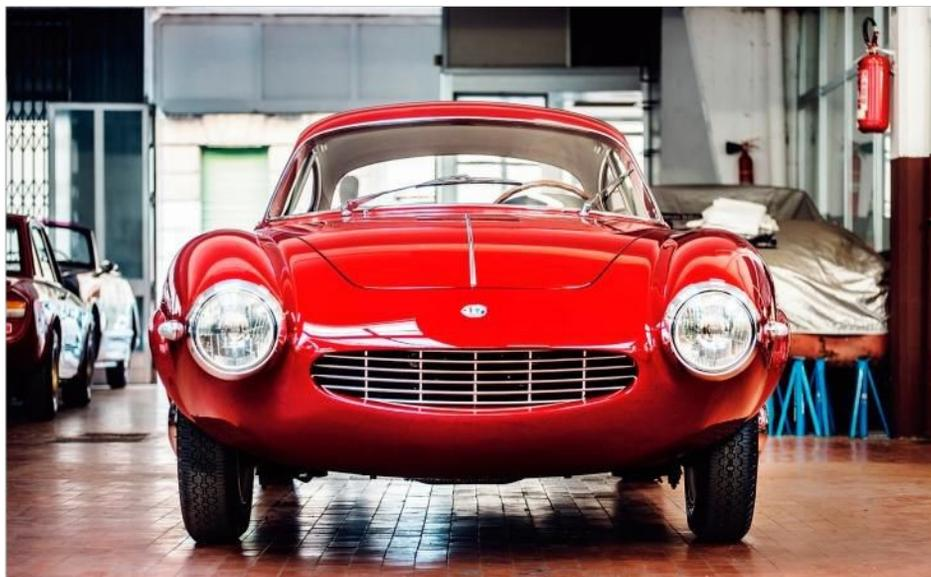
Speciale è più lunga di 26 cm (424 cm contro 398) e più larga di 13 (166,5 cm contro 153,5). La carrozzeria è realizzata in alluminio e quella linea così aerodinamica venne ottenuta modificando la posizione del radiatore e rendendo snodabile in due punti il piantone del volante grazie all'adozione di due giunti cardanici.
