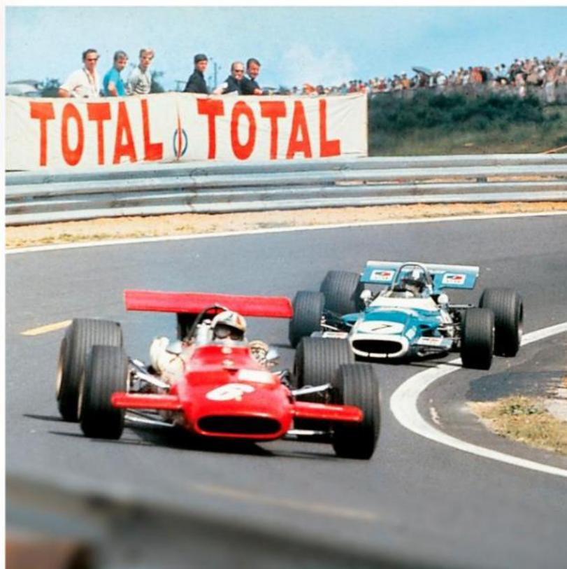
musetto è più profilato e viene adottato l'alettone posteriore che poi, a partire dal G.P. del Belgio del 1968, diventa a incidenza variabile (con comando idraulico a disposizione del pilota). Nel 1969, anche a seguito del cambio dei regolamenti, imposto dai numerosi incidenti causati dal distacco dell'ala, l'alettone scompare, poi diventa fisso e di dimensioni ridotte.
