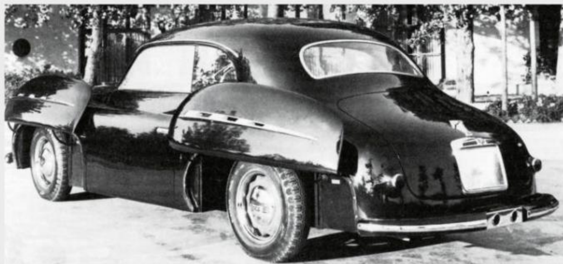
Lancia Aprilia - 1950 Sul pianale Lancia Aprilia (motore V4 di 1486 cm 3 , 48 CV) fu allestita nel 1950 una berlina due porte della serie "flamboyant". La foto mostra le due carenature mobili sui passaruota in posizione aperta.
