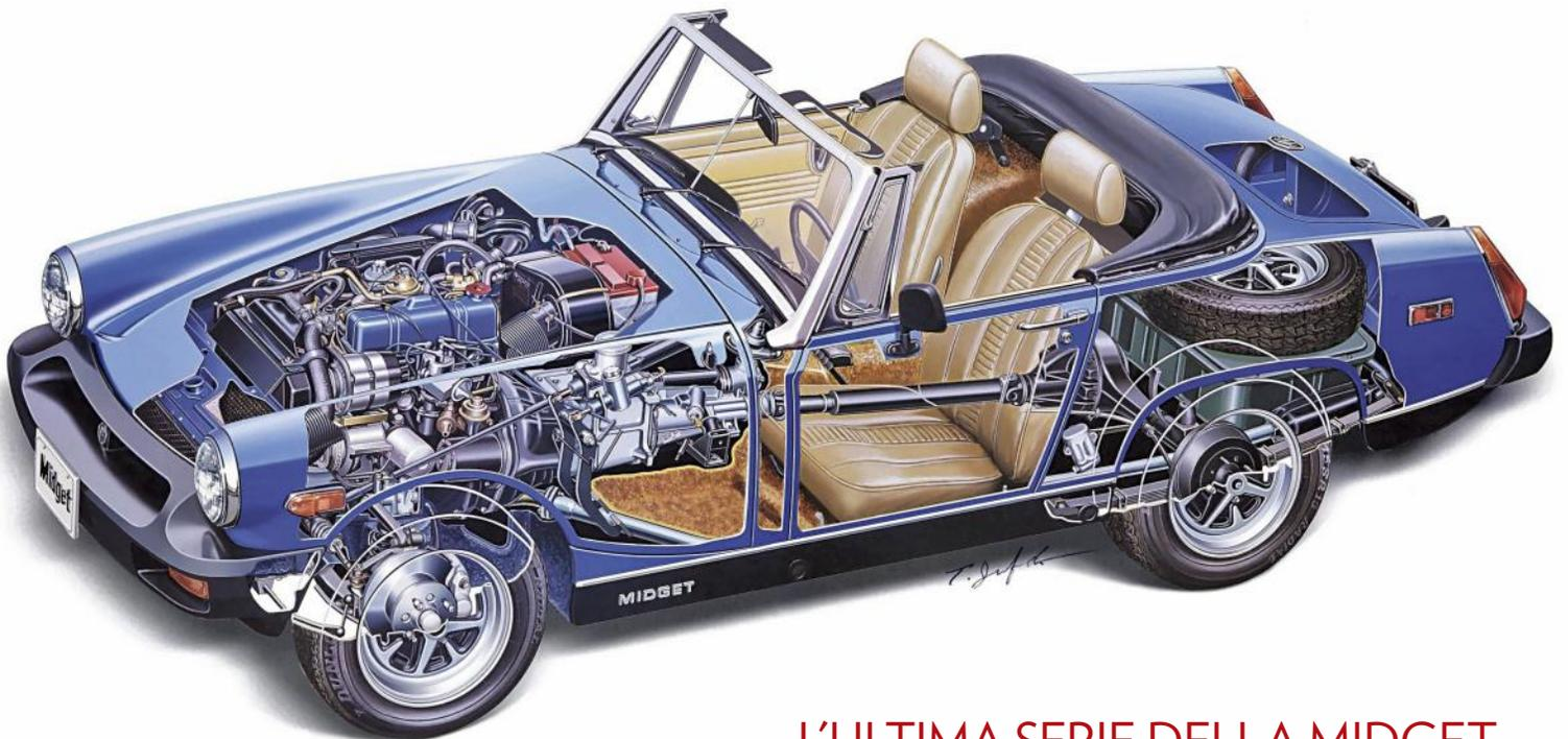
**L'ULTIMA SERIE DELLA MIDGET MONTA IL MOTORE 1.500 DELLA TRIUMPH SPITFIRE. I PARAURTI DI RESINA APPESANTISCONO LA LINEA**
