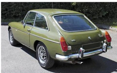
inizia a montare sulle MG B dei suoi clienti il motore della Rover 3500, è meno balzana di quello che sembra, perché il V8 in alluminio di origine Buick, che la British Leyland ha iniziato a usare nel 1967 sulla Rover P5 B, è molto leggero: pesa addirittura 20 kg in meno rispetto al quattro cilindri di 1.8 litri. L'adattamento
