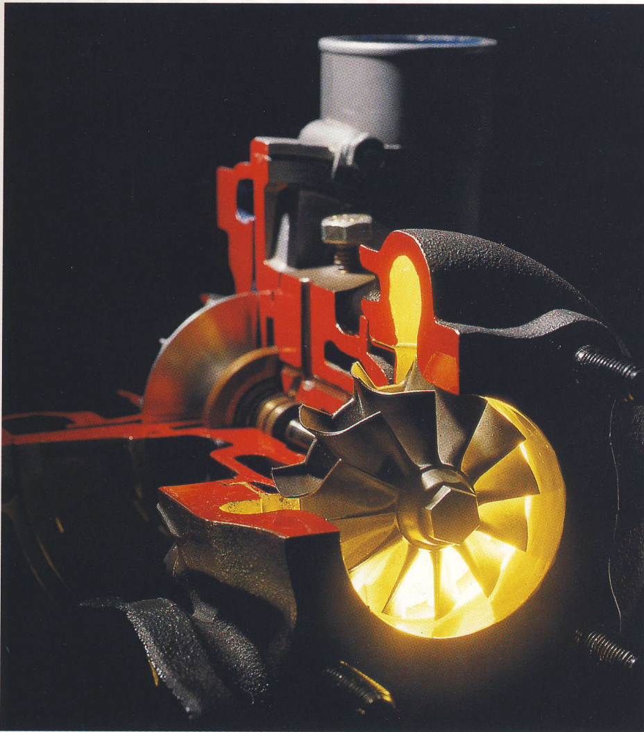
Heiße Sache: Die Abgasturbine läuft mit über 100 000 Umdrehungen pro Minute im Abgasstrom.
