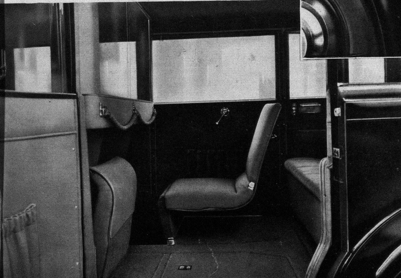
Eine Deckenlampe im Innern leuchtet beim Öffnen der Fondtür auf. Außerdem sind im Fond noch zwei Ecklampen mit separatem Schalter vorhanden. Für das Führerabteil ist eine besondere Ventilation vorgesehen.
