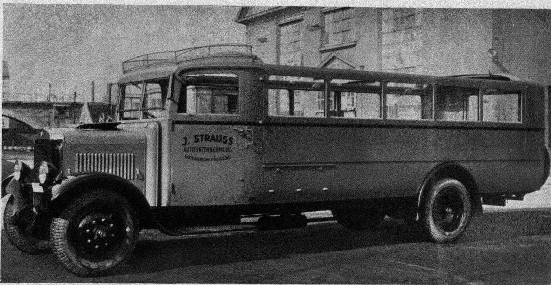
Type O-25, 60 PS, kombiniert, als Autobus oder Lastwagen für 3½ Tonnen Nutzlast zu verwenden.
