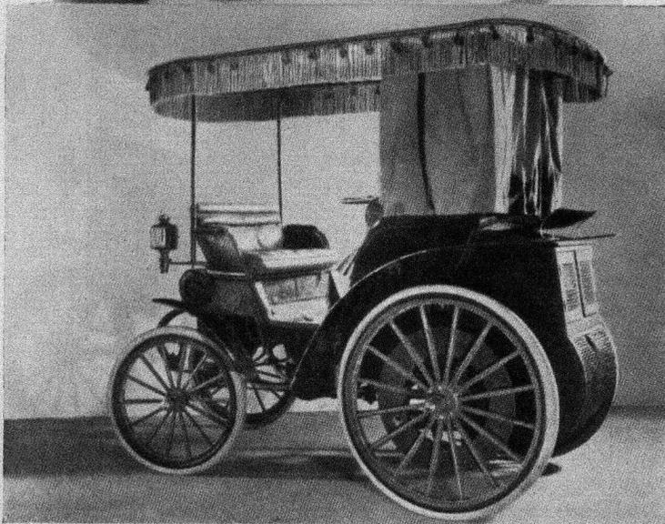
Erster viersitziger Heckmotorwagen mit Riemenantrieb und Schraubenfederung aus dem Jahre 1889.
