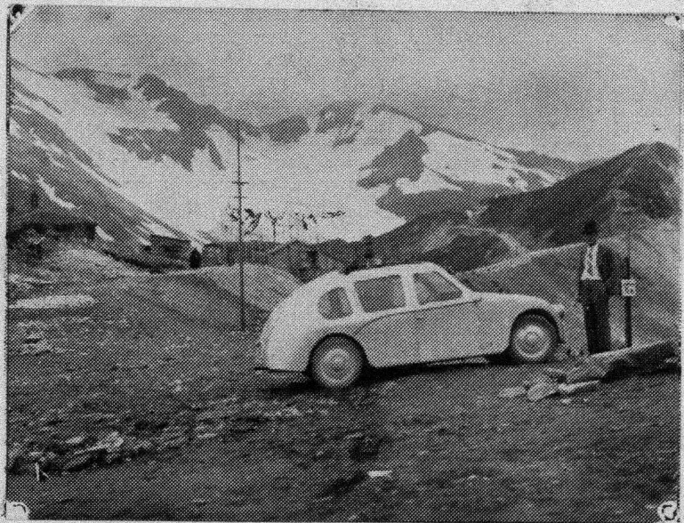
Die neue österreichische Kleinwagentype Smith, mit 500 cm 3 Zweizylinder - Maschine, besucht den Großglockner. Der Wagen soll nach Lösung der finanziellen Frage im Assembling-Verfahren hergestellt werden und als viersitzige, viertürige Stromlinienlimousine, zum Preise von rund S 4500.— auf den österreichischen Markt kommen.
